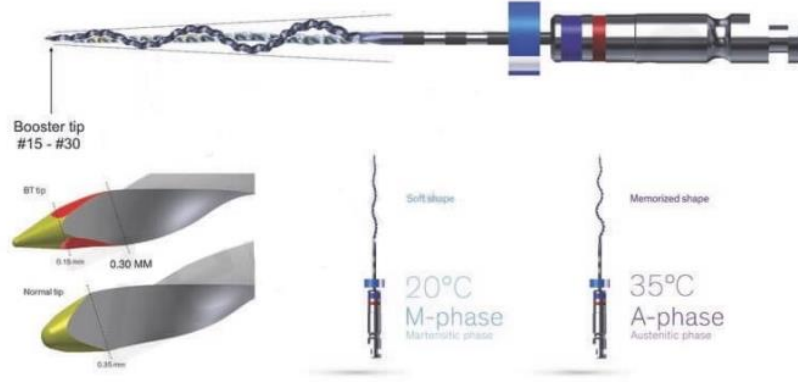
Şekil 8: XP endo Shaper eğerinin uç tasarımı ve metalürjik yapısı
