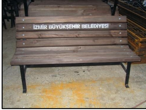
Şekil 4.172: Tesiste hazır gövdeye ahşap oturma birimi monte ediliyor
