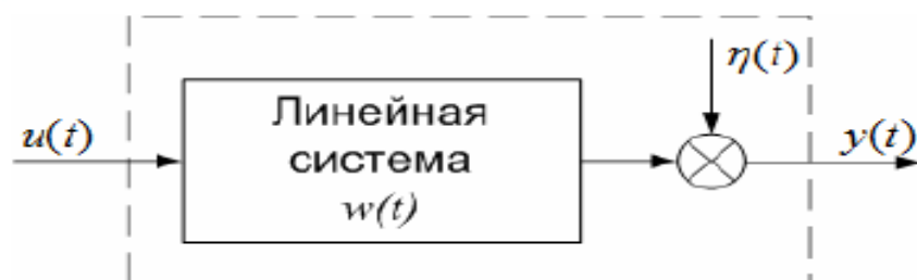
Рисунок 10: Схема идентификационного эксперимента по оценке импульсной весовой функции объекта.
