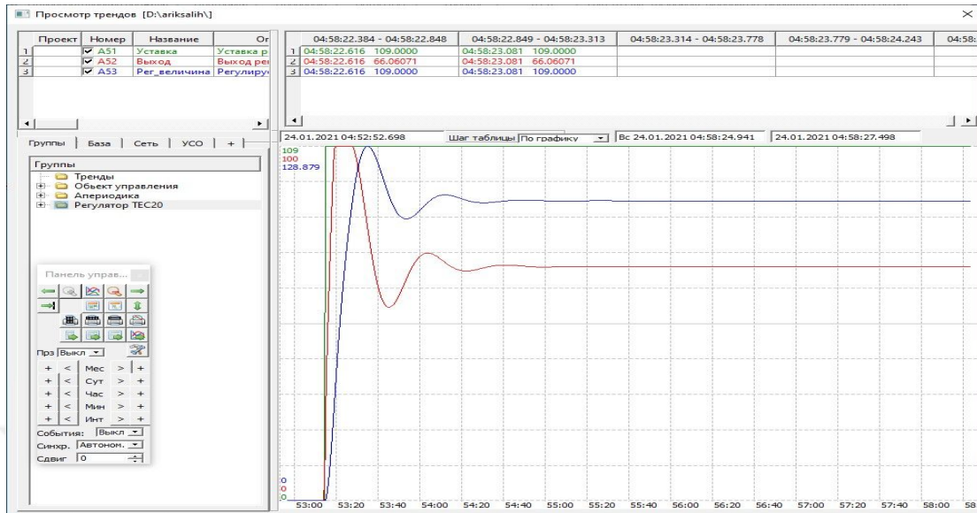
Рисунок 40: Переходная характеристика давления при K=0.2 и T_i=1
