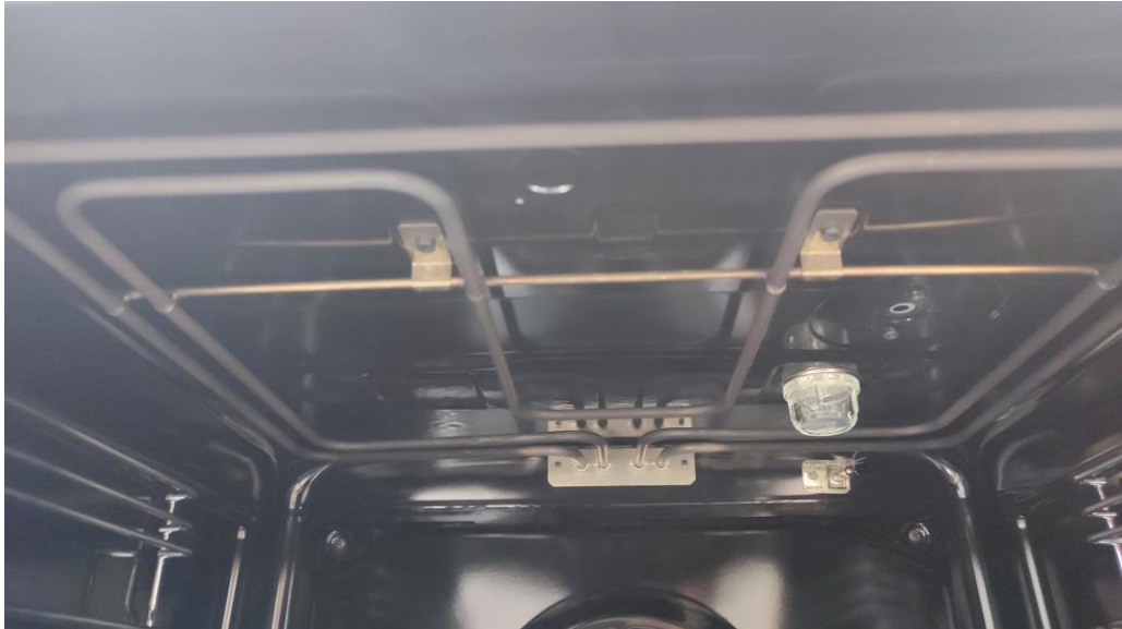
Şekil 3.9 Ev Tipi Elektrikli Fırın Üst Rezistans Yerleşimi
