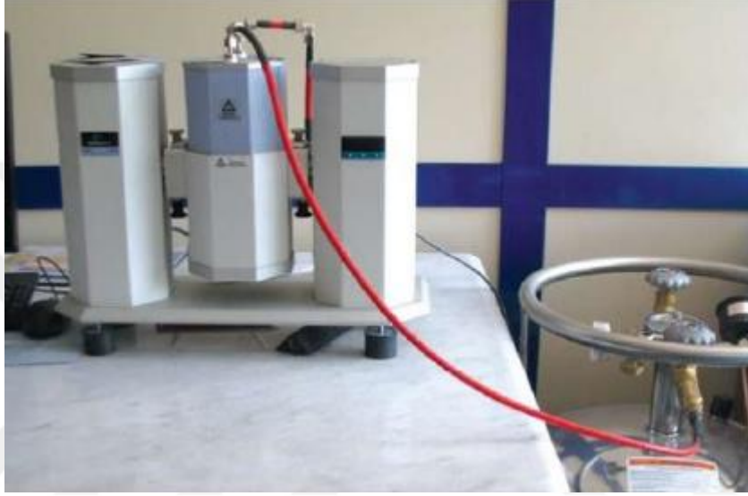
Şekil 3.8. Perkin Elmer 8000 markalı dinamik mekanik analiz cihazı [1].
