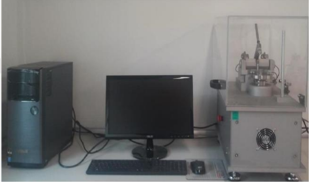
Şekil 3.9. UTS Tribometer T10 aşınma testi cihazı [2].
