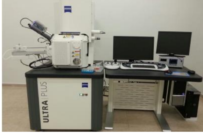
Şekil 3.5. Carl Zeiss Ultra Plus Gemini marka FESEM cihazı [1].
