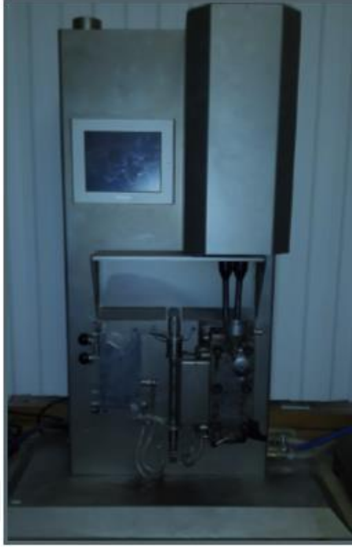
Şekil 3.2. Laboratuvar ölçekli çift vidalı mikro ekstrüder cihazı [2].
