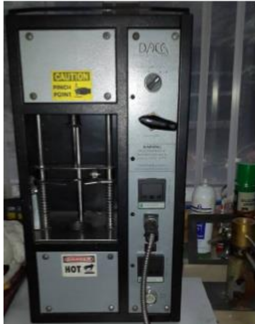
Şekil 3.3. Mikro enjeksiyonlu kalıplama cihazı [2].
