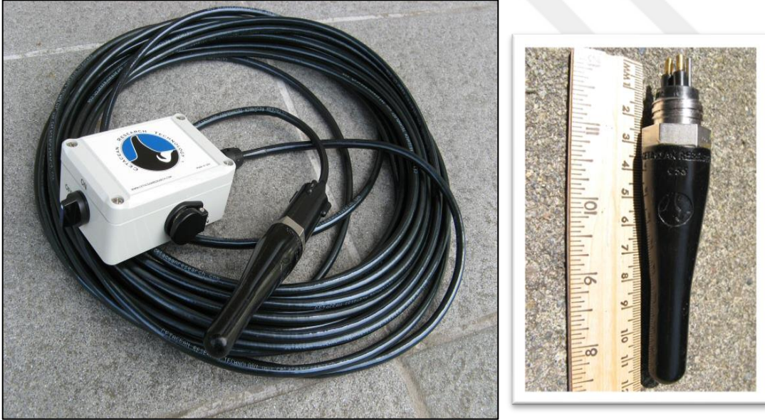
Şekil 10. CRT- C55 Hidrofону ve Kablosu
