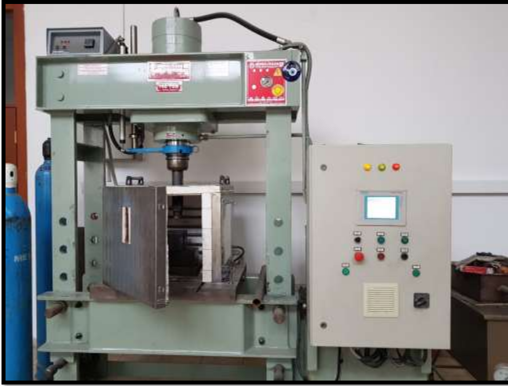
Resim 5.2. Sıkıştırma işlemi yapılan tek eksenli hidrolik presleme cihazı
