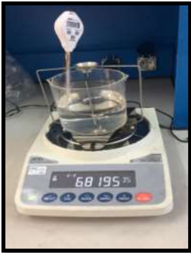
Resim 5.5. Yoğunluk ölçümlerinde kullanılan 10^{-4} g hassasiyetindeki Arşiment test ünitesi
