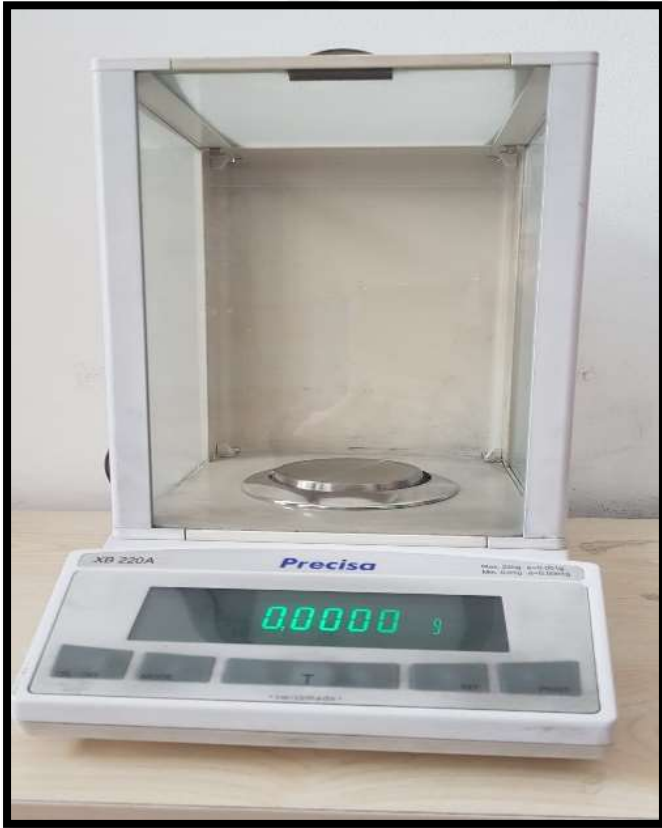
Resim 5.1. 10^{-4} g hassasiyetine sahip elektronik hassas terazi
