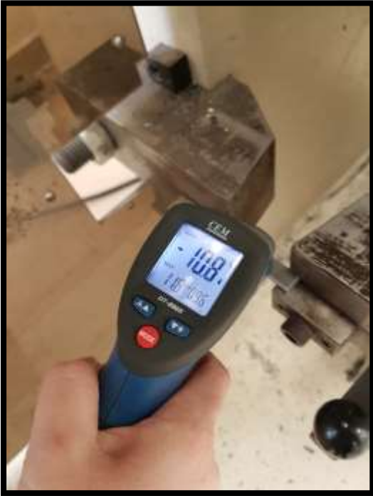
Resim 5.12. Sıcaklık kontrolü için kullanılan lazer termometre
