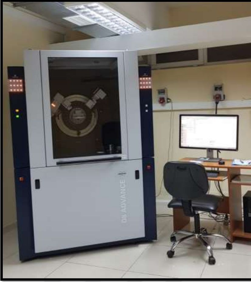
Resim 5.8. XRD analizleri için kullanılan D8 Advance marka cihazın görüntüsü
