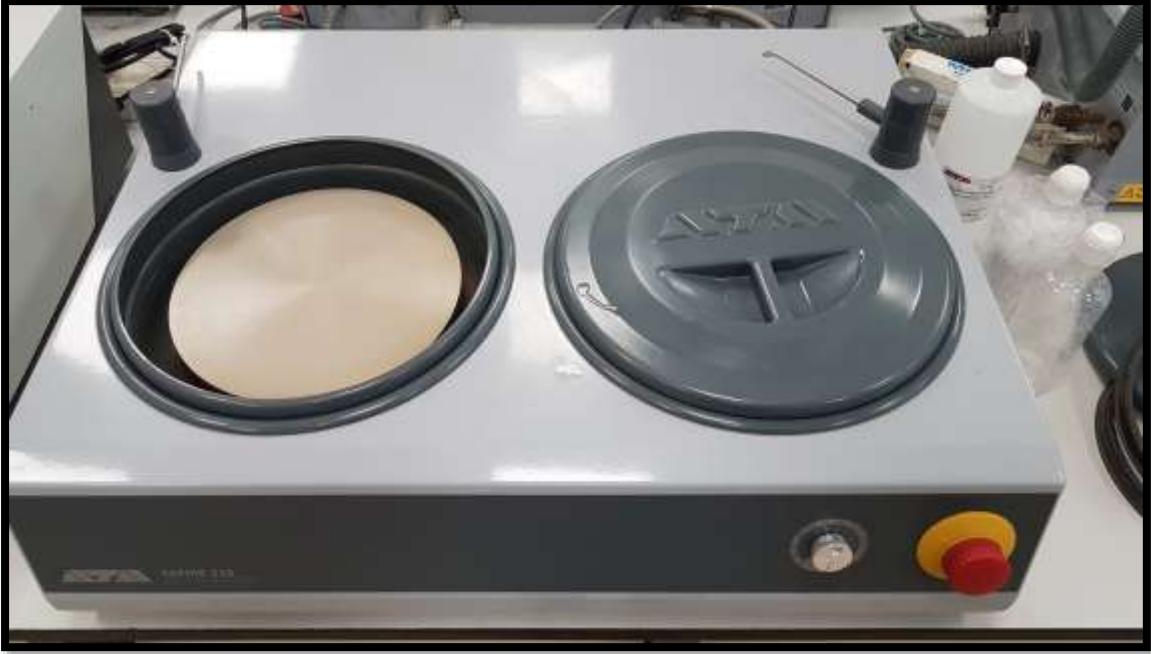
Resim 5.6. Metalografik işlemler için kullanılan zımparalama ve parlatma cihazı
