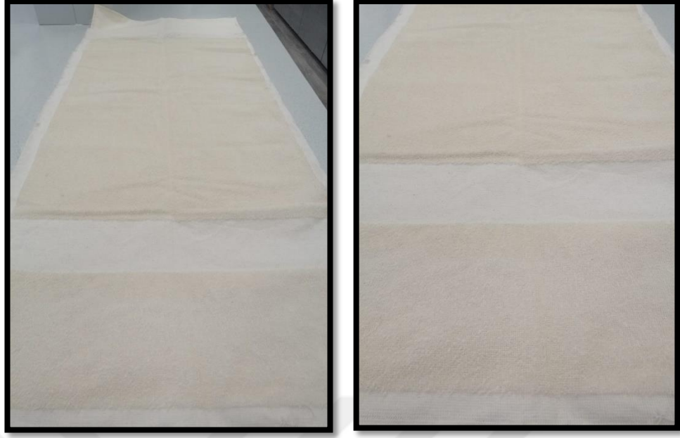
Şekil 3.21. Dokunan havlu yüzeylerin ham hali
