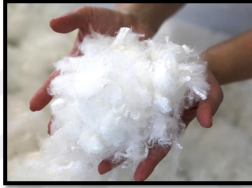
Şekil 3.8. %30-35 boşluklu kesikli hollow elyaf
