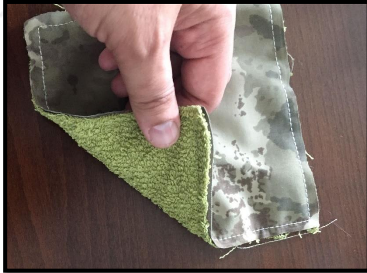
Şekil 3.22. Geri dönüştürülmüş iplikler ile elde edilen havlu ara katman
