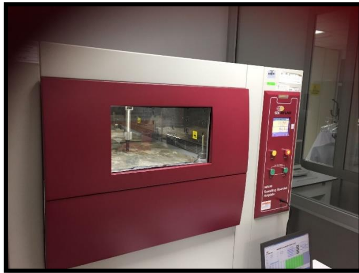
Şekil 3.31. Terleyen levha test cihazı ve ısı direnç (rct) ölçüm yöntemi
