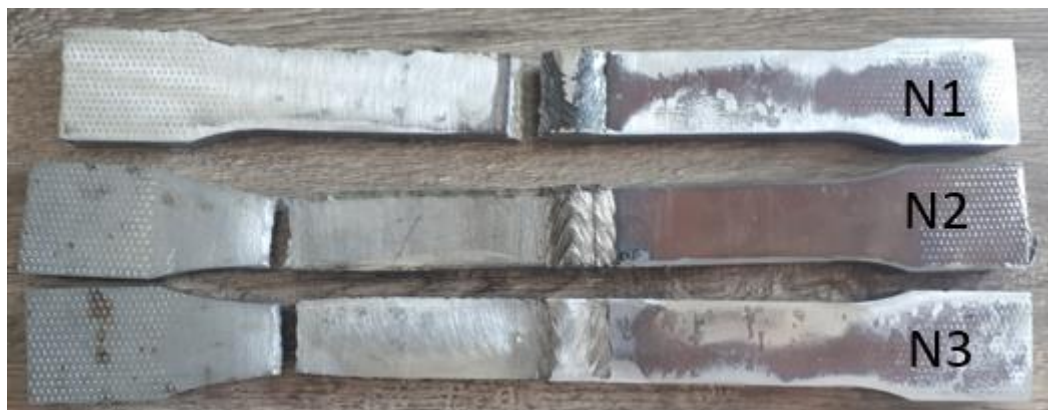
Şekil 91. N1, N2, N3 numunelerinin çekme deneyi sonrası makro görünüşleri
