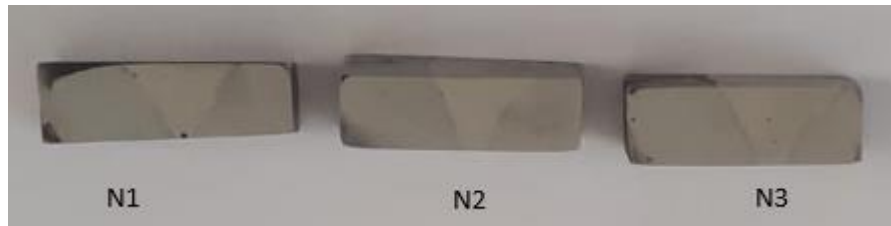
Şekil 32. N1, N2 ve N3 numunelerinin arakesit alınmış makroyapı görüntüleri
