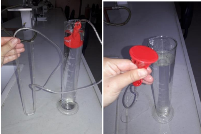
Şekil 4.20. Sıvı basıncı ve derinlik ilişkisi deneyi
