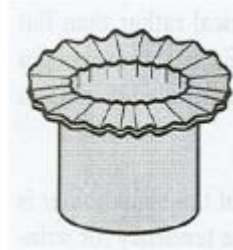
Şekil 2.1 :Flanş Bölgesi Kırışması [20]
