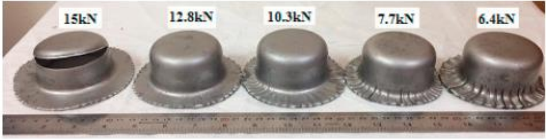
Şekil 1.12: Pot Basıncının Kapların kırışmasına etkisi [39]
