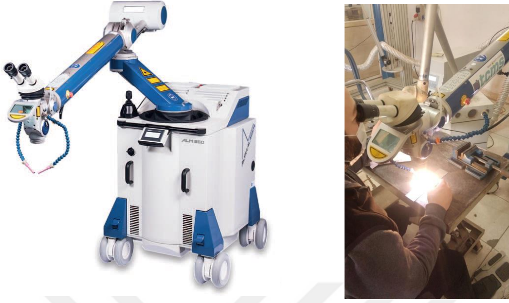
Şekil 3.1 Numunelerin kaynağında kullanılan kaynak makinesi görünüşü.
