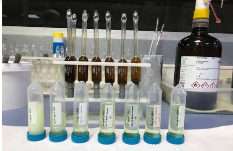
Gerber Yöntemiyle Peyir Altın Suyu Yağ Tayini Düzeneği
