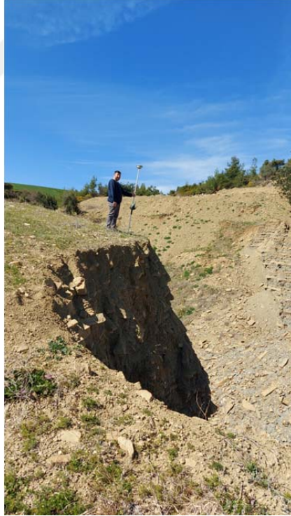
Őekil 4.9. Total Station GPS ile sahada lm yapılması (Heyelanın st kısmı)
