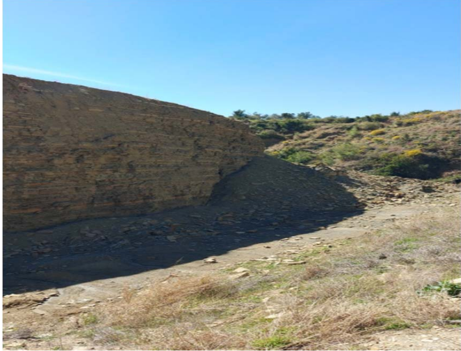
Őekil 4.6. Cingöz Formasyonu (Tci); kum-kumtaŐı-kil-kiltaŐı ardalanması kayan kütle görünümü (Batıdan doğuya bakıŐ)
