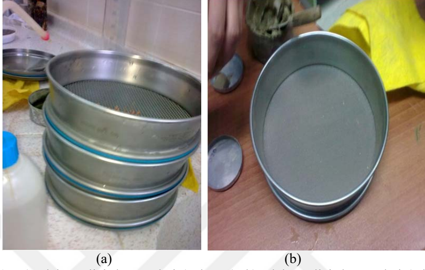
Şekil 3.2. a) Elek analizi deney aleti (üçlü set), b) Elek analizi deney aleti (tekli set)
