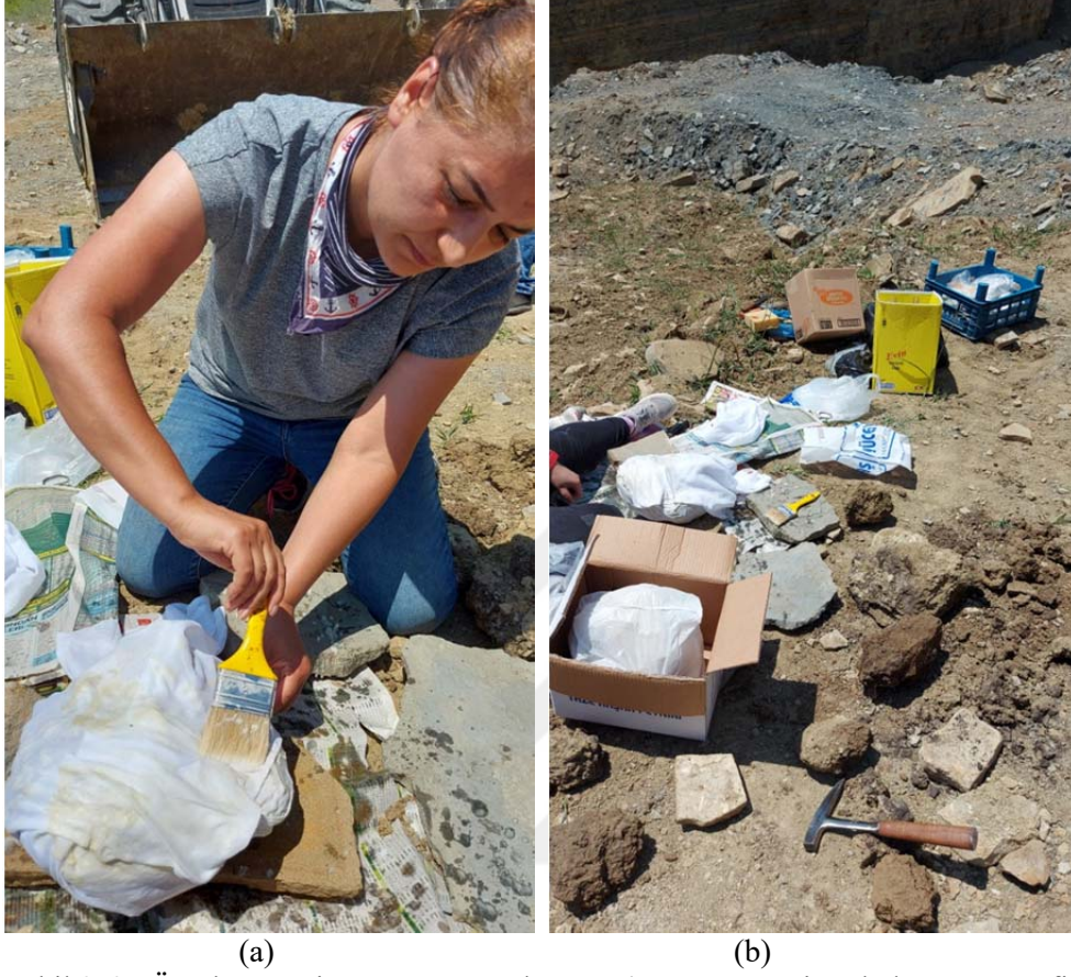
Şekil 3.6. Örselenmemiş numune alımı; a) Numunenin balmumu-parafin karışımıyla izole edilmesi b) İzole edilen numunelerin korunaklı olarak muhafaza edilmesi
