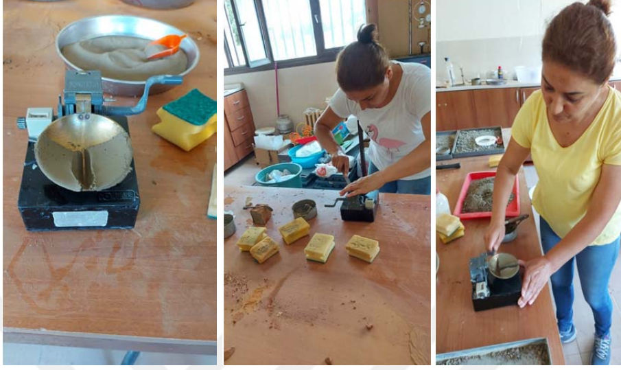
(a) (b) (c) Şekil 3.3. Likit Limit deneyinin yapılışı; a) Casagrande aleti ve zemin numunesi içerisinde likit limit kaşığı ile açılmış oyuk, b) Deney aşamasından görünüm (genel), c) Deney aşamasından görünüm (yakın plan)
