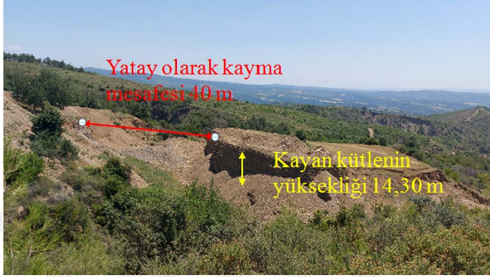
Şekil 4.10. Cingöz Formasyonu (Tci); kum-kumtaşı-kil-kiltaşı ardalanması kayan kütle görünümü (Kuzeydoğudan Güneydoğuya bakış)
