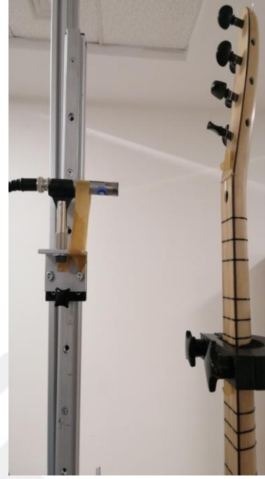
Şekil 3.31. Sap ses (dikey 80 cm) kafesi, yakın (yatay 20 cm) ölçüm
