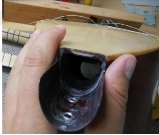
Şekil 3.18. Tekneye sabitlenmiş metal bağlantı aparatı
