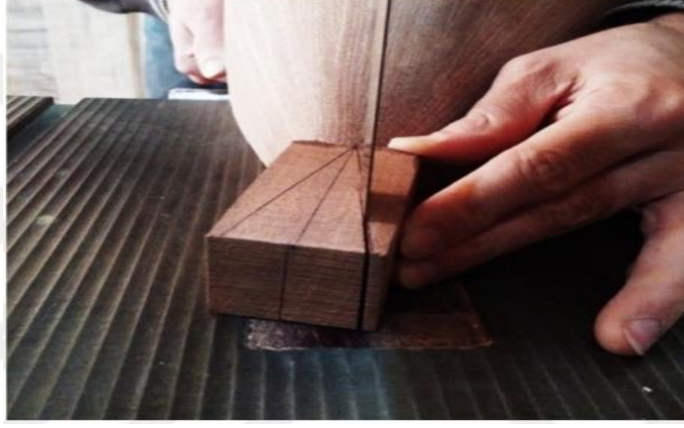
Şekil 2.11. Tekne ön takozunun kesimi (Çiçekçiođlu, 2017: s.76)
