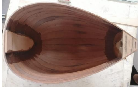
Şekil 3.13. Ardıç bağlama teknesi (ses kutusu) iç görünümü
