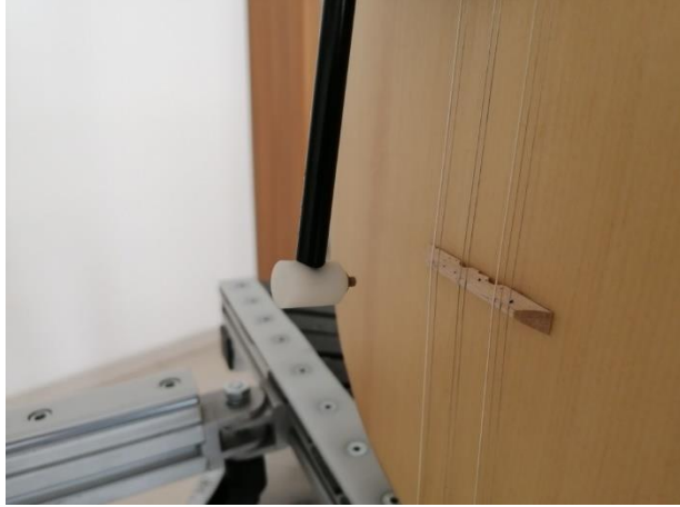
Şekil 3.32. Darbe çekici ve ses analizi yapılan bağlama
