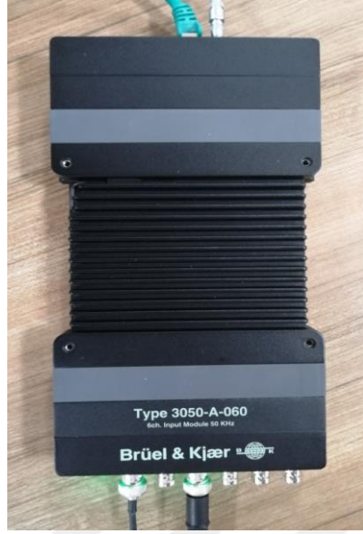
Şekil 3.28. B&K 3050-A-060 Veri Toplama Modülü
