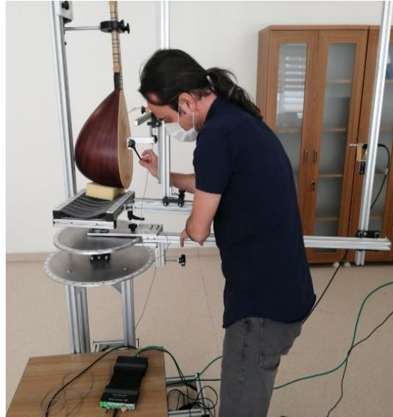
Şekil 3.29. 1 m uzak mesafeden yapılan ses ölçümü
