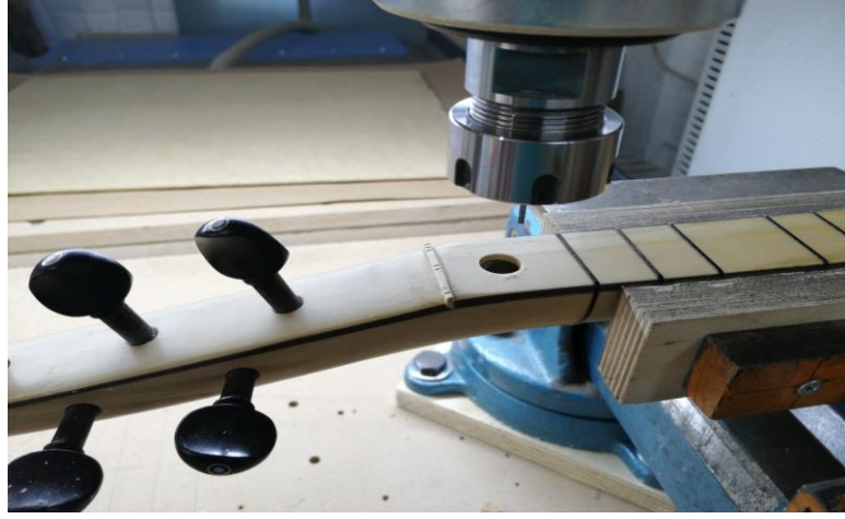
Şekil 3.25. CNC ile 12 mm apında sap ses kafesinin açılması.
