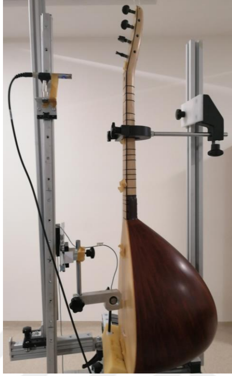
Şekil 3.33. DS ses (dikey 80 cm) kafesi, yakın (yatay 20 cm) ses yayılım ölçümü
