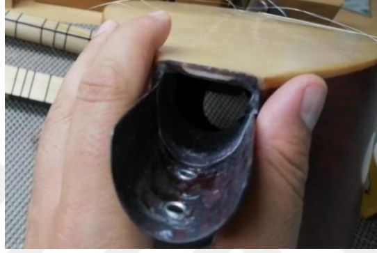
Şekil 3.4. Tekne-sap birleşim yeri metal bağlantı aparatı
