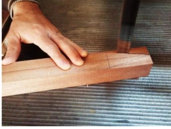
Şekil 2.10. Sapın kesimi (Çiçekçiođlu, 2017: s.76)
