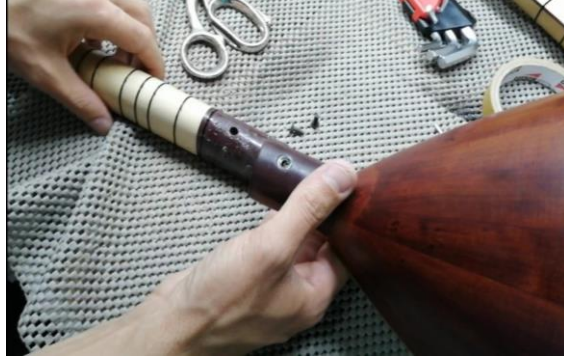
Şekil 3.3. Deneysel sapın tekneden sökülmesi
