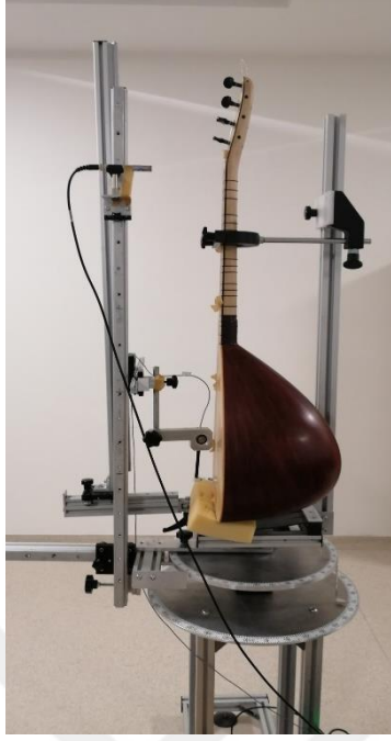
Şekil 3.30. Sap ses (dikey 80cm) kafesi, yakın (yatay 20 cm) ölçüm
