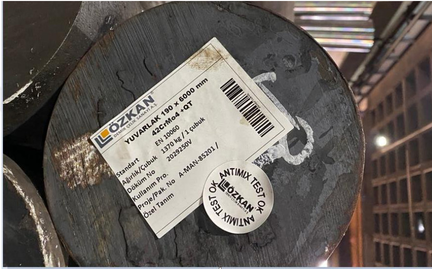
Şekil 4.2. Özkan Demir Çelik firmasından tedarik edilen Ø190x6000 mm ölçülerindeki ham madde
