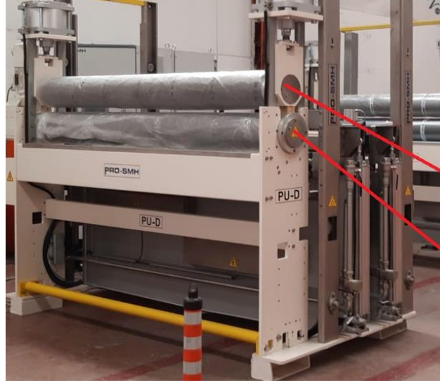
Şekil 4.15. Yıkama teknesinin montaj işlemi tamamlanmış görseli (PROSMH-2022)
