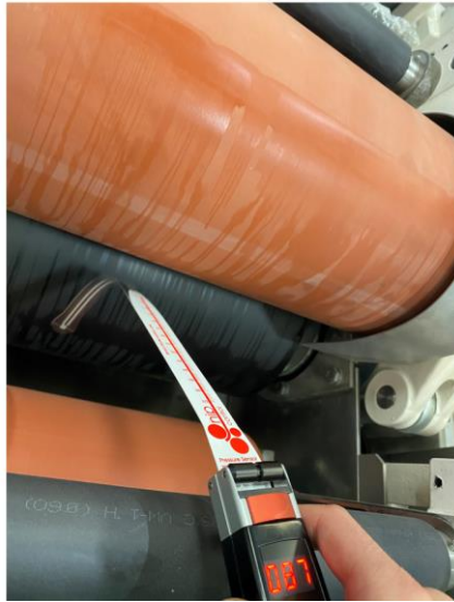
Şekil 4.10. Ara sıkma mekanizmasında Nip basınç ölçümü (PROSMH-2022)
