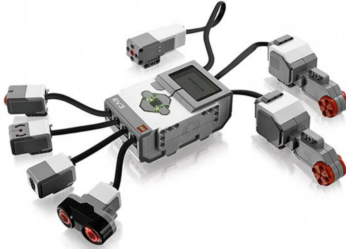
Şekil 1. Lego Mindstorms eğitim kiti.
