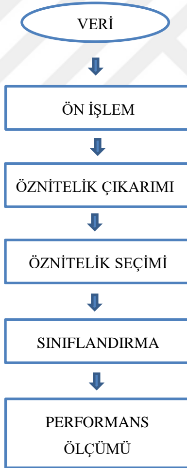
Şekil 4.1 Genel bir örüntü tanıma sistemi akış şeması.
