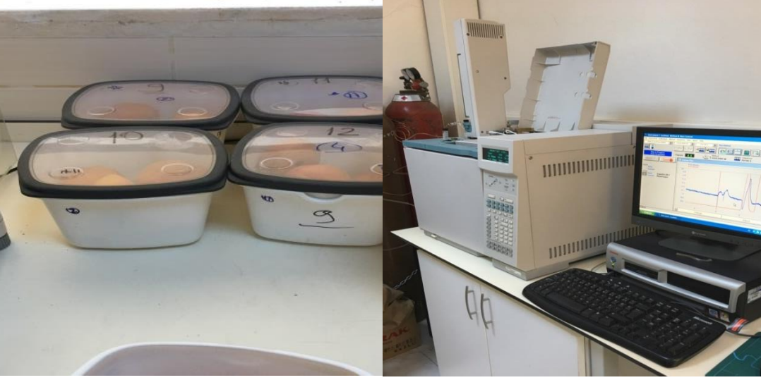
Şekil 3.12. Gaz örneğinin alınışı ve gaz kromatografisi cihazına verilışı.
