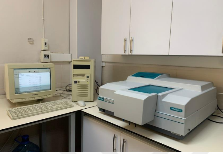
Şekil 3.9. Toplam fenol miktarı ve antioksidan aktivitesinin belirlenmesinde kullanılan spektrofotometre.
