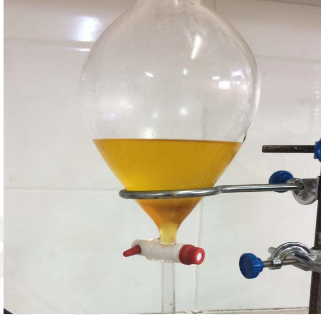
Fotoğraf 4.4. Transesterifikasyon Reaksiyonu Sonunda Faz Ayrılması
