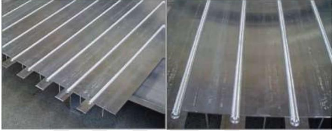
Şekil 2.7. SKK ile üretilmiş güverte ve yan panelleri (Besharati-Givi, M.K., Asadi, P.2014).
