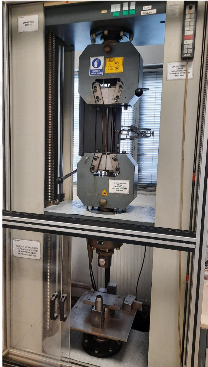
Şekil 3.5. Zwick 150 Sac çekme cihazı
