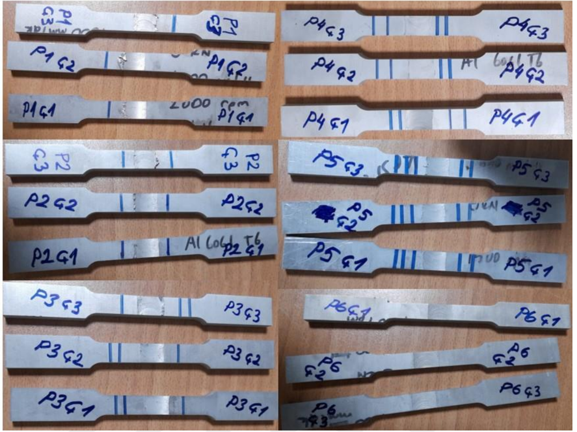
Şekil 3.8. Çekme Test Numuneleri
