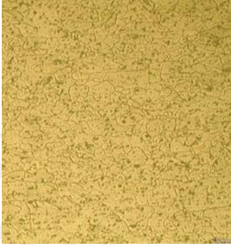
Şekil 3.1. Al 6061 T6 malzemesi iç yapı görseli
