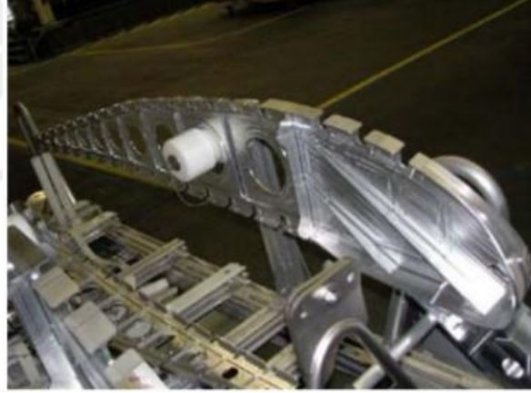
Şekil 2.6. Airbus A380 modelinin SKK uygulanmış bir flap kesiti (Dalkılıç S. 2012)
