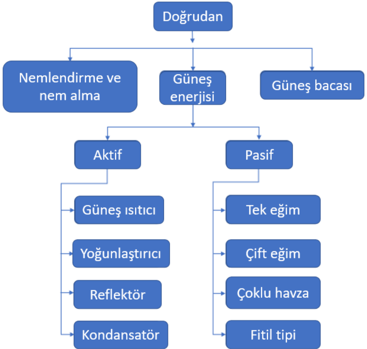
Şekil 1. Doğrudan tuzdan arındırma sistemleri
