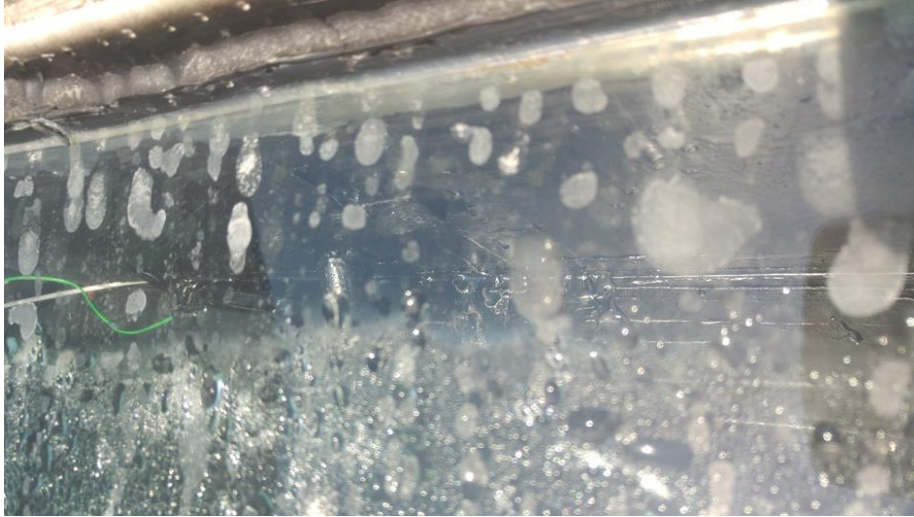
Şekil 29. Yoğuşma olmayan ölü bölge
