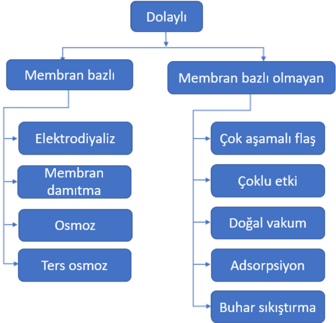
Şekil 2. Dolaylı tuzdan arındırma sistemleri
