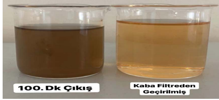
Şekil 4.14 Akrilik Viskon karışımı İplik Üretim Tesisinin Opak Siyah Rengine Sahip Atıksuyun 100.Dk Kaba Filtreden Geçirilmiş Hali
