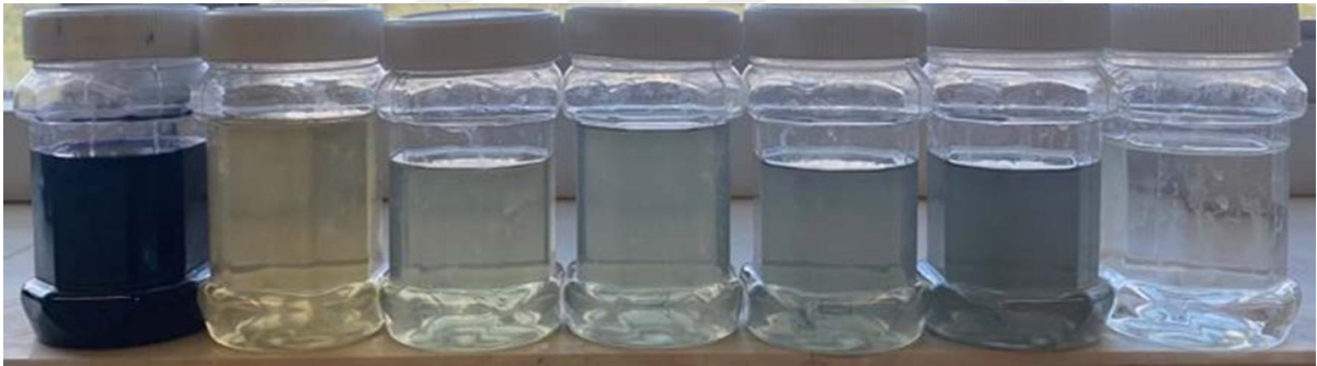
Şekil 4.22 Yuvarlak Örgü Kumaş Boyama Banyosundan Kaynaklanan Atıksuyun Pilot Ölçekli Tesiste Arıtılması
