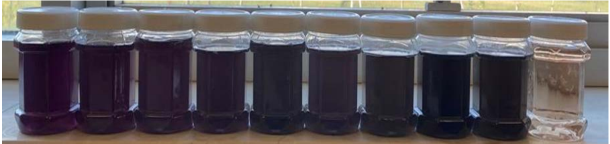
Şekil 4.21 Yuvarlak Örgü Kumaş Boyama Banyosundan Kaynaklanan Atıksuyun Pilot Ölçekli Tesiste Arıtılması
