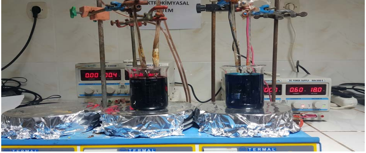
Şekil 3.1 Laboratuvar Ölçekli EO Arıtma Sistemi
