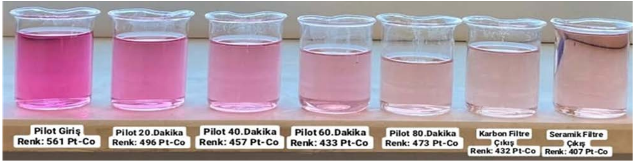
Şekil 4.16 Yuvarlak Örgü Kumaş Boyama Banyosundan Kaynaklanan Pembe Renge Sahip Atıksuyun Pilot Ölçekli Tesiste Arıtılması
