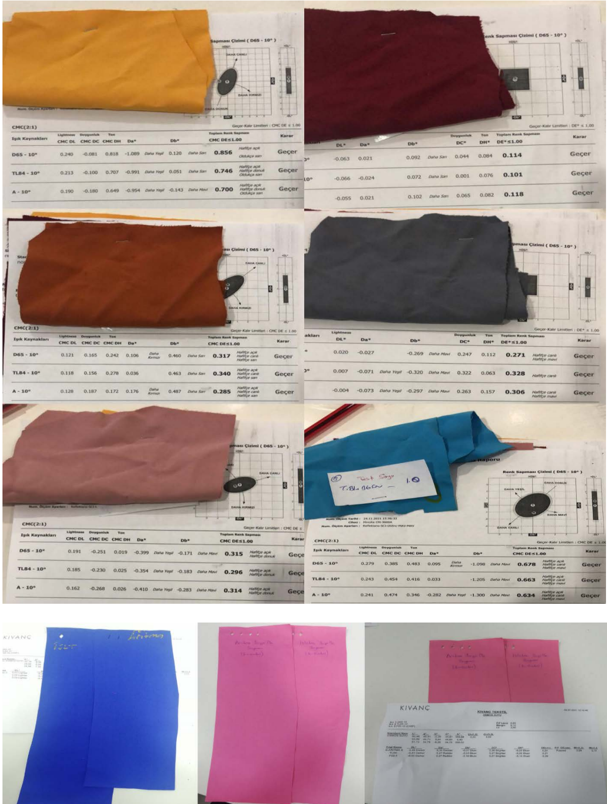
Şekil 4.33 Geri Kazanılan Tuzlu Su İle Gerçekleştirilen Kumaş Boyamaları
