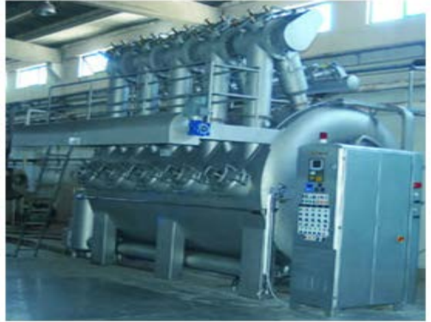
Şekil 4.32 Jet boyama makinesi ve elemanları, 1. Kumaş, 2. Flotte, 3. Düze Sistemi, 4. İlave Tankı
