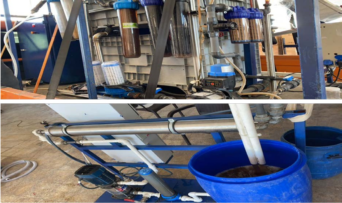
Şekil 3.9. Pilot ölçekli EO+AK+NF Membran Arıtma Tesisi
