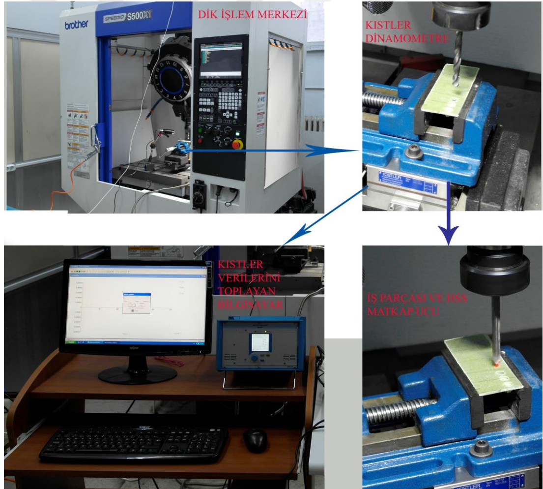
Şekil 3.7 Kesme kuvvetinin ölçülmesi
