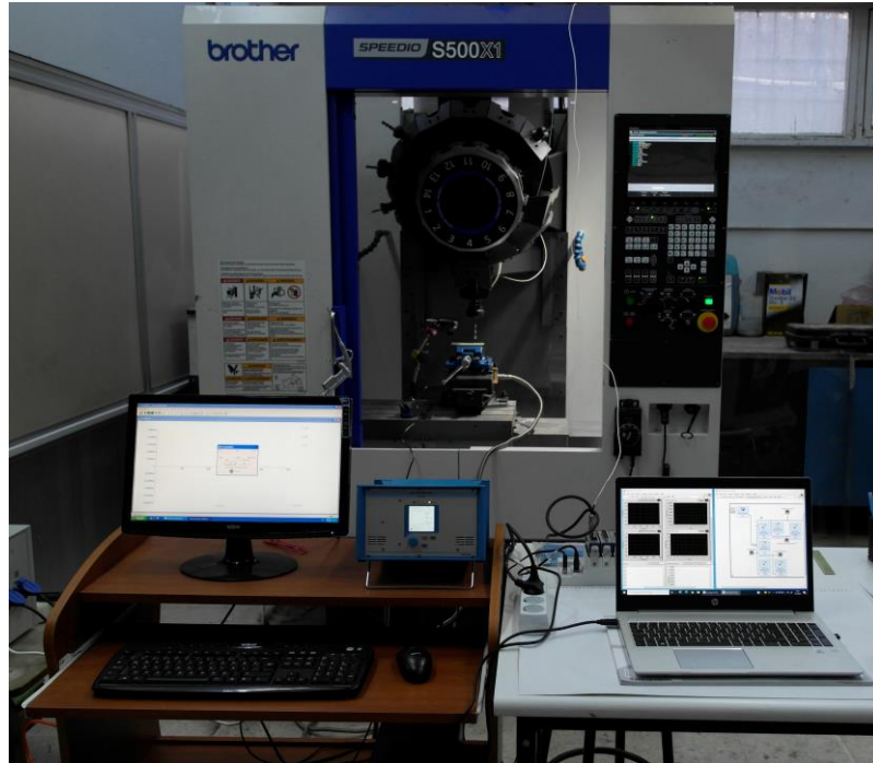
Şekil 3.6 KETP Kompozitlerin Delinmesinde Kullanılan Dik İşlem Merkezi
