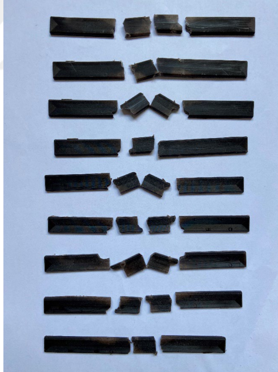
Şekil 4.19. Hindistan Cevizi + PP numunelerinin darbe testi sonrası görüntüsü
