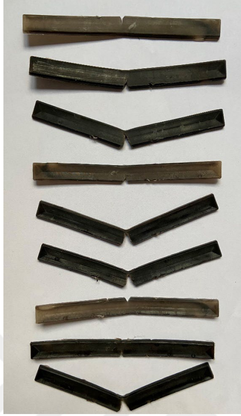
Şekil 4.22. Turba + PE numunelerinin darbe testi sonrası görüntüsü
