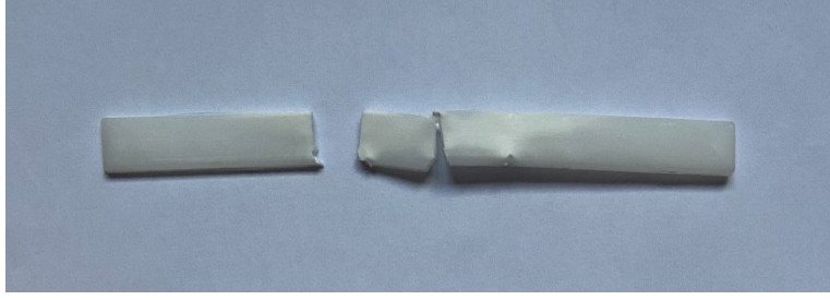
Şekil 4.17. Saf Polipropilen numunesinin darbe testi sonrası görüntüsü
