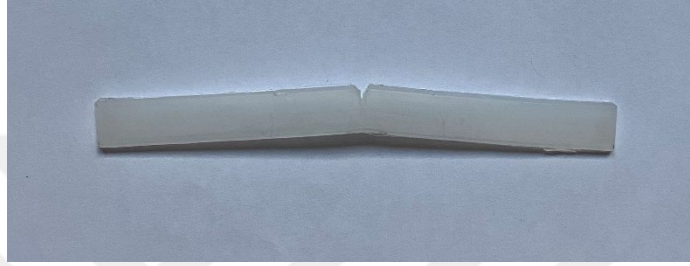
Şekil 4.18. Saf D.Y Polietilen numunesinin darbe testi sonrası görüntüsü
