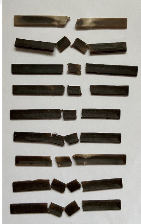
Şekil 4.23. Palmiye + PP numunelerinin darbe testi sonrası görüntüsü
