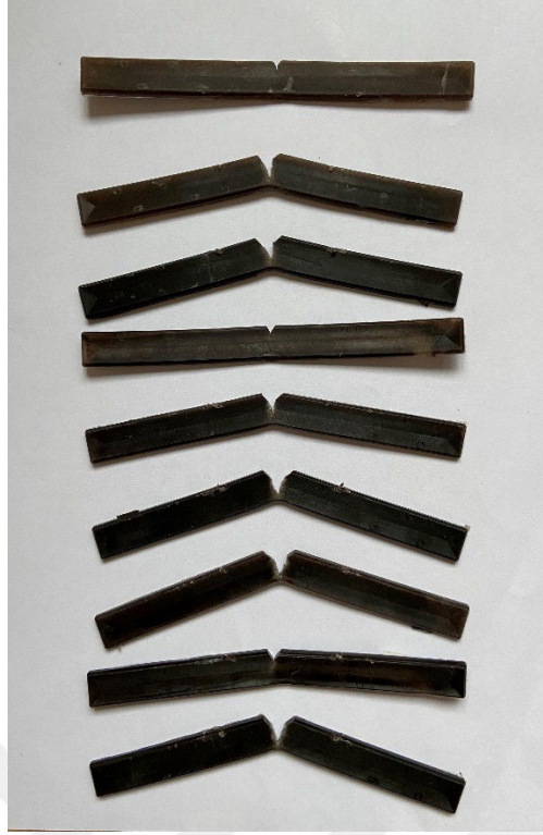
Şekil 4.20. Hindistan Cevizi + PE numunelerinin darbe testi sonrası görüntüsü
