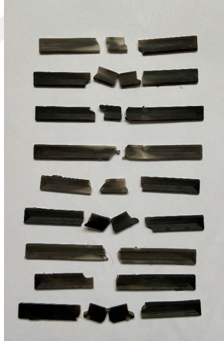
Şekil 4.21. Turba + PP numunelerinin darbe testi sonrası görüntüsü
