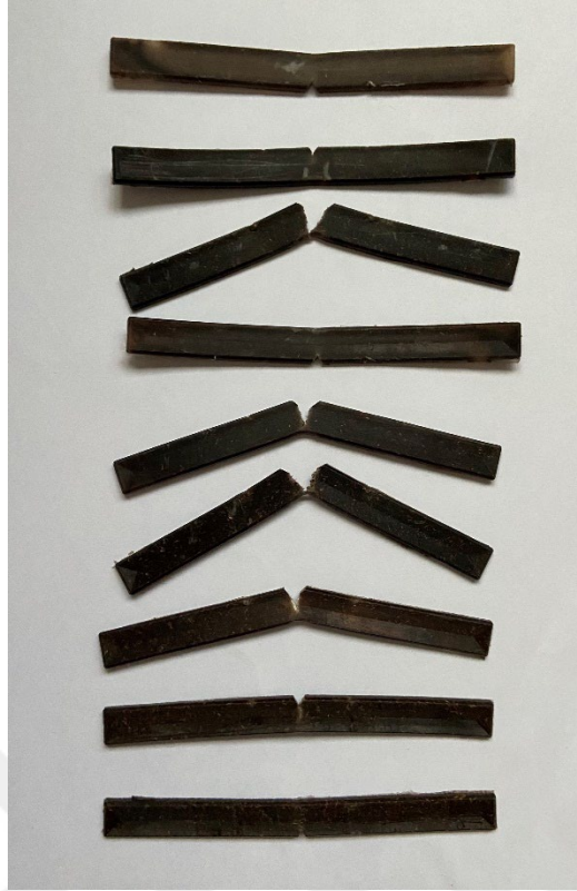
Şekil 4.24. Palmiye + PE numunelerinin darbe testi sonrası görüntüsü
