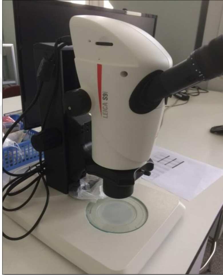
Şekil 3.1. Trikom sayım ve fotoğraf çekimleri için kullanılan ve proje bütçesinden alınan Leica S9i stereomikroskop
