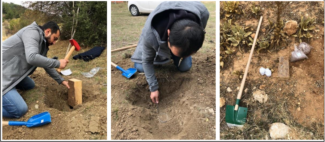
Şekil 3.6. Doğal yapısı bozulmuş ve bozulmamış toprak örneklerinin araziden alınması
