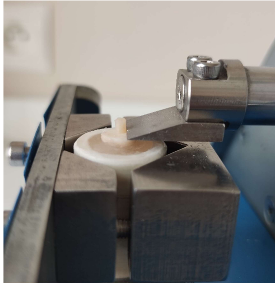
Şekil 3.6. Bloğun cihaza yerleştirilmiş hali ve kırılma öncesi görüntüsü
