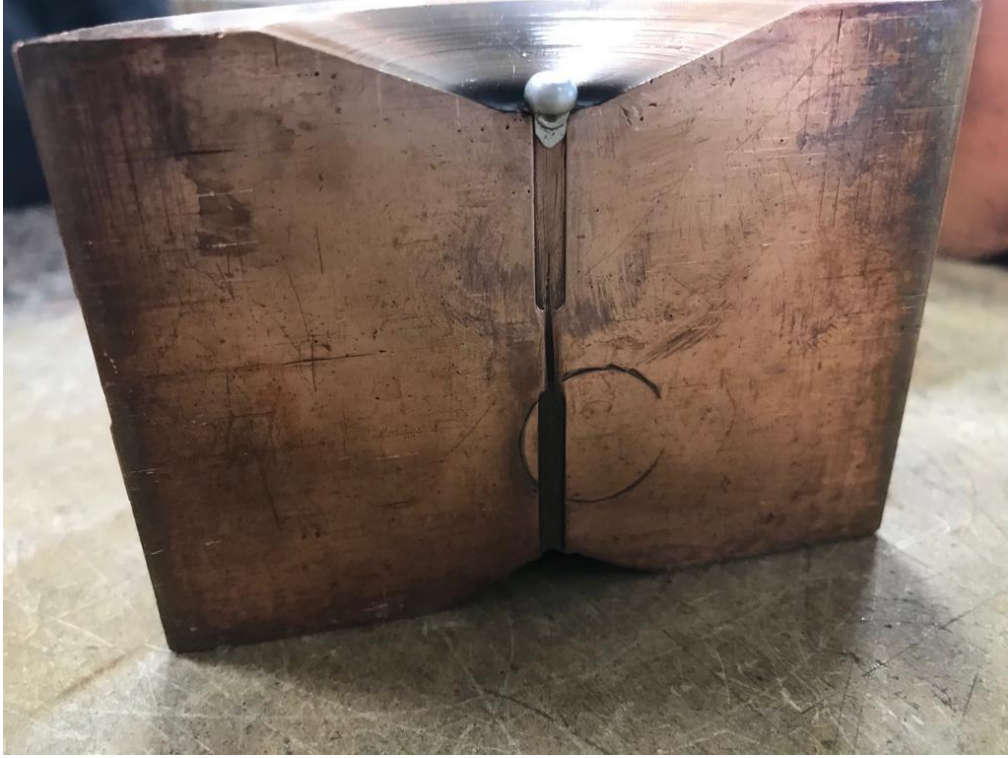
Şekil 3. 3 Bakır kalıba döküm işlemi.
