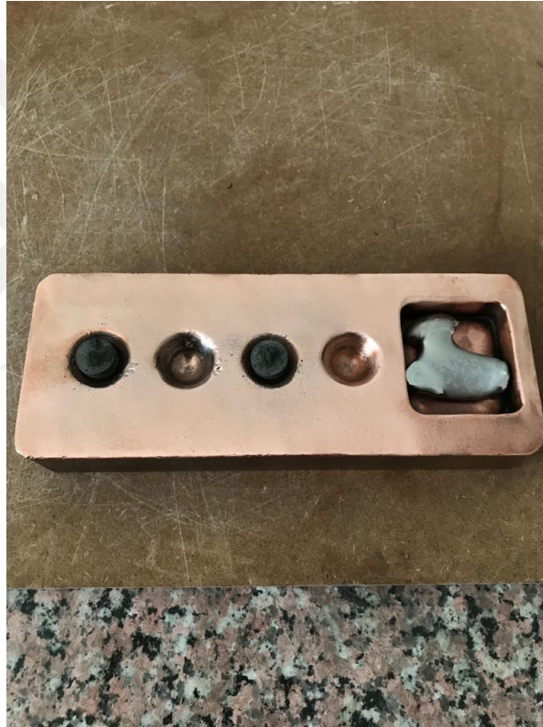
Şekil 3. 2 Bakır kalıpta ergitme işlemi.
