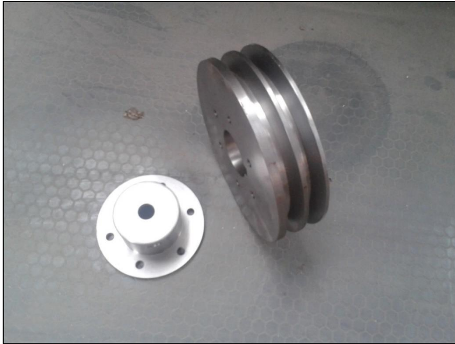
Şekil 3.38. Elektrik motoru kasnak fotoğrafı
