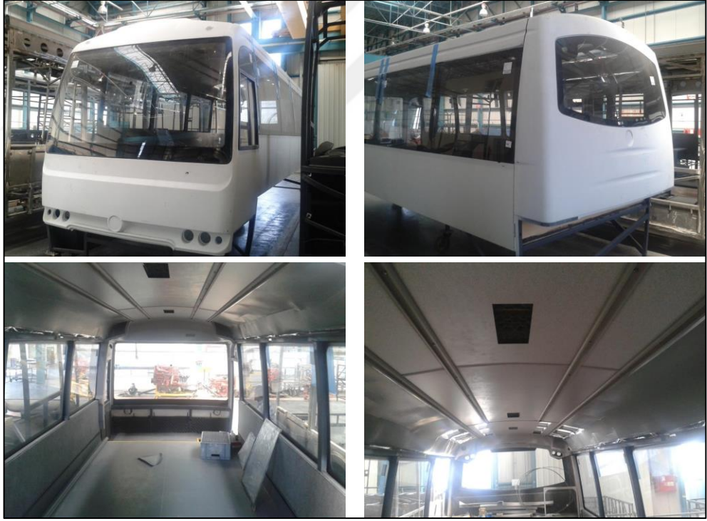
Şekil 3.27. Test karkası iç ve dış trim montajına ait fotoğraflar
