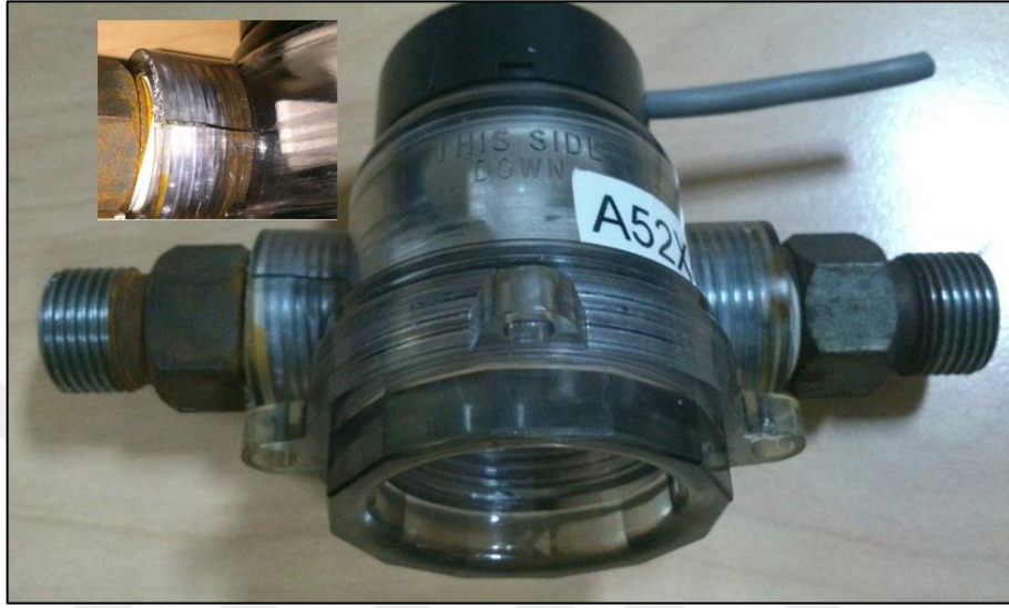
Şekil 3.49. Polikarbon malzemeden imal edilen debiölçerlerde meydana gelen çatlama problemi
