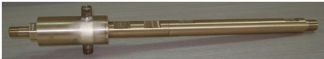
Söz konusu ejektör imalatı için farklı imalatçılar ile görüşülmüştür. Özellikle difüzör imalatı için uygun imalatçı bulmada problemler yaşanmıştır. Difüzörün 307mm uzunluğunda konik bir delikten oluşması, düşey yönde bu uzunlukta kurs mesafesi olan elektro erozyon tezgahı olan bir firma olmasını gerektirmektedir. Hazırlanan 3D resme göre imal edilen ejektöre ait fotoğraf da Şekil 3.32’de verilmiştir.
