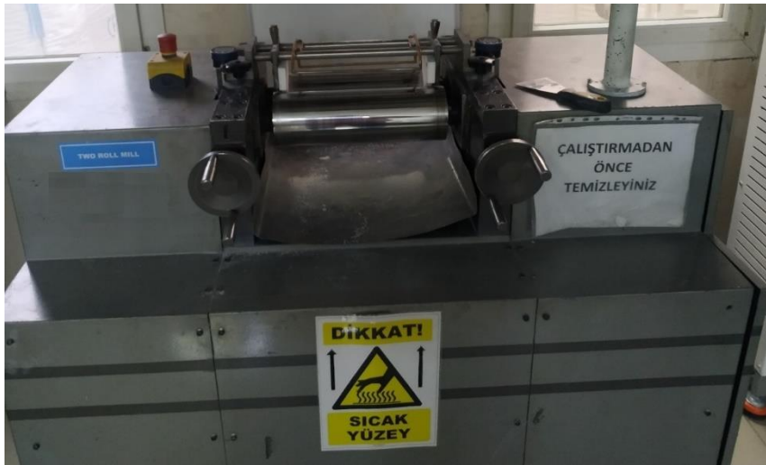
Şekil 5.3 Laboratuvar tipi kalenderleme cihazı
