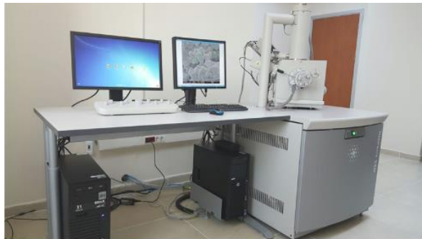
Şekil 5.7 Taramalı elektron mikroskobu (SEM)
