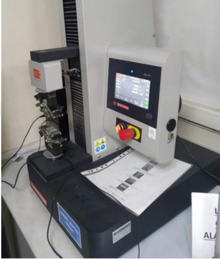
Şekil 5.8 Çekme testi cihazı
