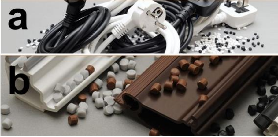
Şekil 2.2 Yumuşak ve sert PVC görselleri (a) Yumuşak PVC (b) Sert PVC
