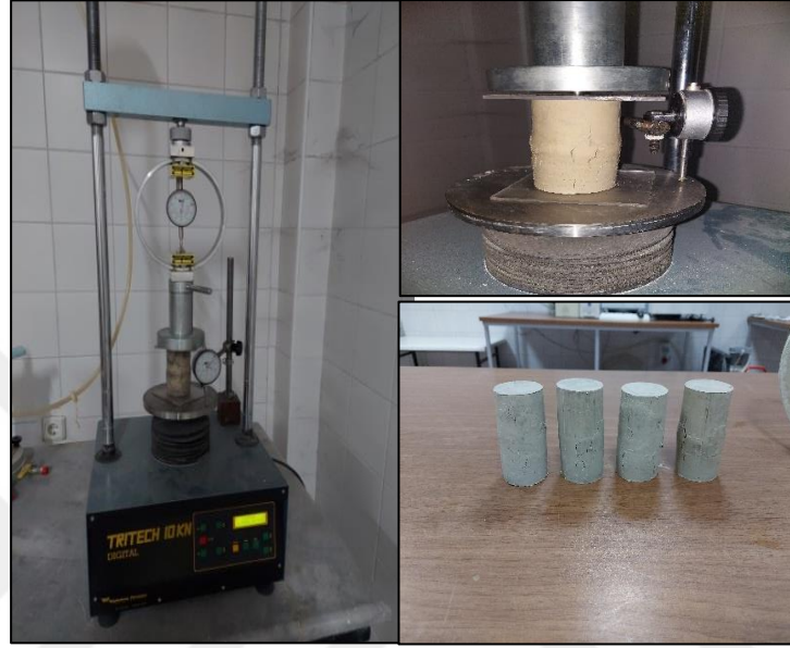
Fotoğraf 5.8. Serbest basınç deney cihazı ve deney sonrası numune görünümleri
