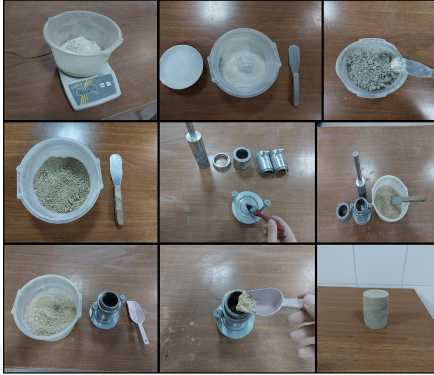
Fotoğraf 5.6. Deney numunesi hazırlama aşamaları
