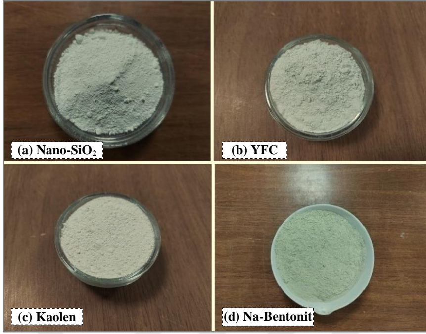
Fotoğraf 5.1. Deneyde kullanılan malzemeler: Nano-SiO 2 (a), YFC (b), Kaolen (c), Na-Bentonit (d)
