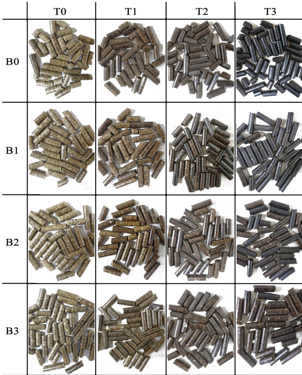
Şekil 4.4. Artan buhar düzeyleri (B0, B1, B2, B3) ile peletlenmiş ve artan sıcaklıklarda (T0, T1, T2, T3) torefiye edilmiş sera domates sapı artıkları peletleri
