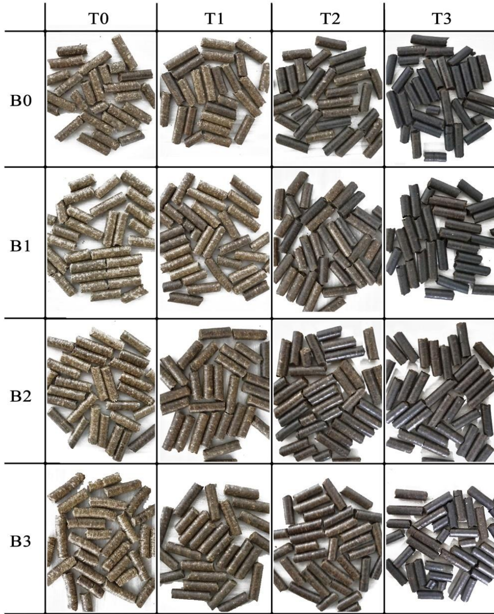
Şekil 4.5. Artan buhar düzeyleri (B0, B1, B2, B3) ile peletlenmiş ve artan sıcaklıklarda (T0, T1, T2, T3) torefiye edilmiş zeytin budama artıkları peletleri
