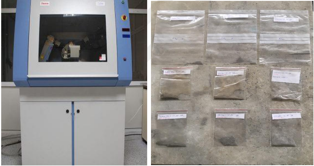
Şekil 4.11 Thermo Scientific ARL K-Alpha XRD cihazı ve analiz edilen numuneler
