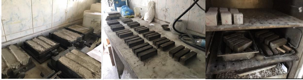
Şekil 5.13 Katkısız KAC harç numuneleri
