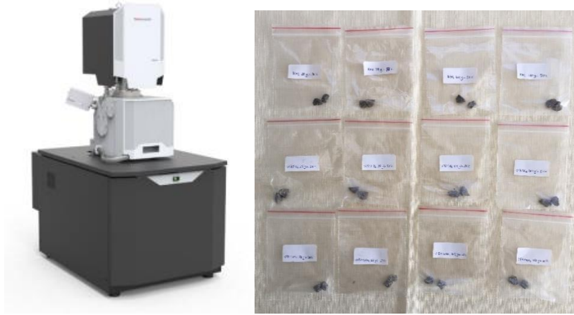
Şekil 4.13 Thermo Scientific Apreo S marka SEM cihazı ve analiz edilen numuneler
