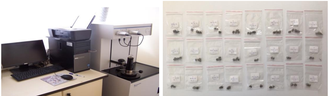
Şekil 4.14 Civa porozimetre analizinde kullanılan cihaz ve analiz edilen numuneler
