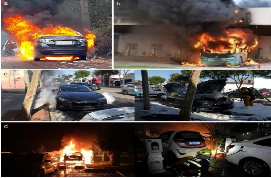
Şekil 3.13: Son yıllardaki tipik EA yangın kazaları: (a) Renault-Samsung elektrikli araç modeli 'SM3.Z.E' 15 Ocak 2016'da Kore'de sürüş sırasında alev aldı (Moon, 2016) (b) 26 Nisan 2015'te Shenzhen, Çin'de bir şarj istasyonunda tamamen pilli bir elektrikli otobüs alev aldı ve bu elektrikli otobüs alev aldığıda şarjda değildi (Pecht, 2015); (c) Bir Tesla Model S, 15 Haziran 2018'de ABD, Kaliforniya'da sürüş esnasında duman çıktı. Yangında 1135 L su ve köpük enjekte edilerek söndürüldü (NTSB, 2018) ; ve (d) EA yangın kazası 20 Mayıs 2018'de Hangzhou, Çin'de bir otoparkta meydana geldi (URL-12).
