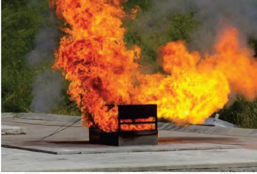
Şekil 3.7. Destekleyici heptan ateşi hala varken LIB 2'nin bir PRD'sinin açılmasından sonra alev parlamasının meydana gelmesi
