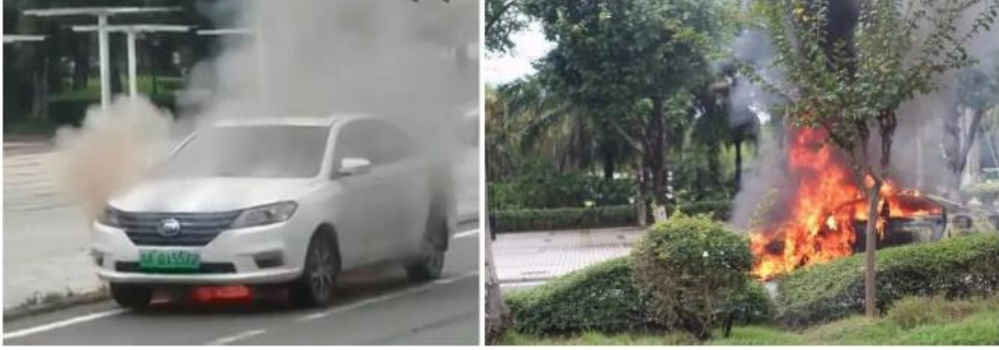
Şekil 3.10. Bir Lifan 650 EV'nin araç şasisine takılı pil takımında yangının başladığı ve EA'nın etkin yangın söndürme olmadan yangınla yok olma durumu (URL-11)
