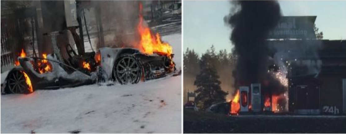
Şekil 3.11. Şarj esnasında yanan bir elektrikli araç
