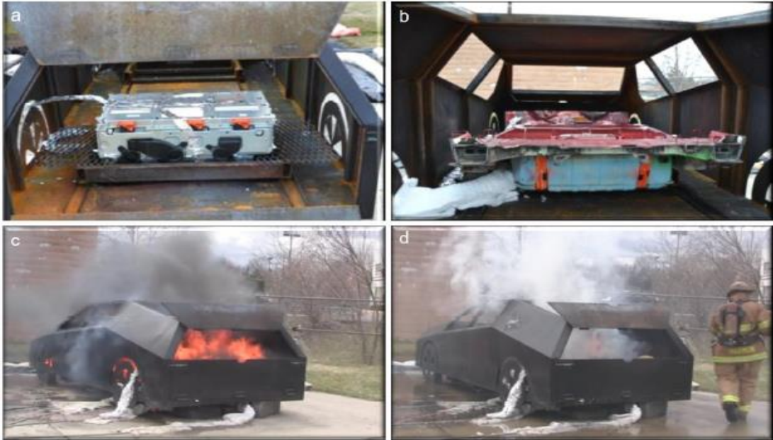
Şekil 5.1. Bir araç modeli içindeki EA pil takımlarının tam ölçekli yangın söndürme testi: (a) A Tipi pil takımı; (b) İç bileşenleri olan B Tipi pil takımı; (c) Batarya A'nın yangın davranışları; ve (d) yangın söndürme çabaları (Blum ve diğ., 2015; Colella, 2016)
