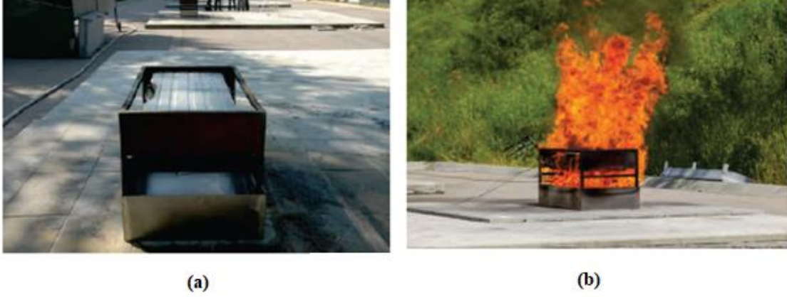
Şekil 3.5. Yangınla mücadele testi (a): Bir tepsiye yerleştirilmiş destek çerçevesindeki pil; (b): Ateşleme kaynağı olarak n-heptan ile doldurulmuş hali
