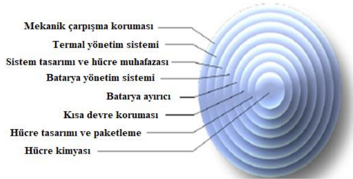
Şekil 4.1 EA'lar için pil yangın güvenlik sistemi seviyelerinin şematik diyagramı (Larsson ve diğ., 2016)
