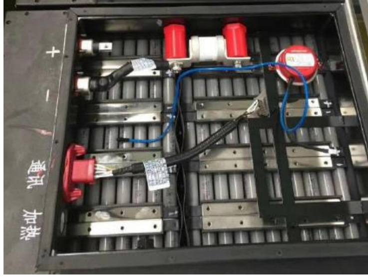
Şekil 5.3. Batarya paketi içerisine monte edilmiş aerosol yangın söndürücü
