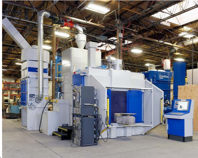
Şekil 2.3. Uçak motoru bileşenleri için kullanılan bilyeli dövme sistemi (Progressive Surface,2022)
