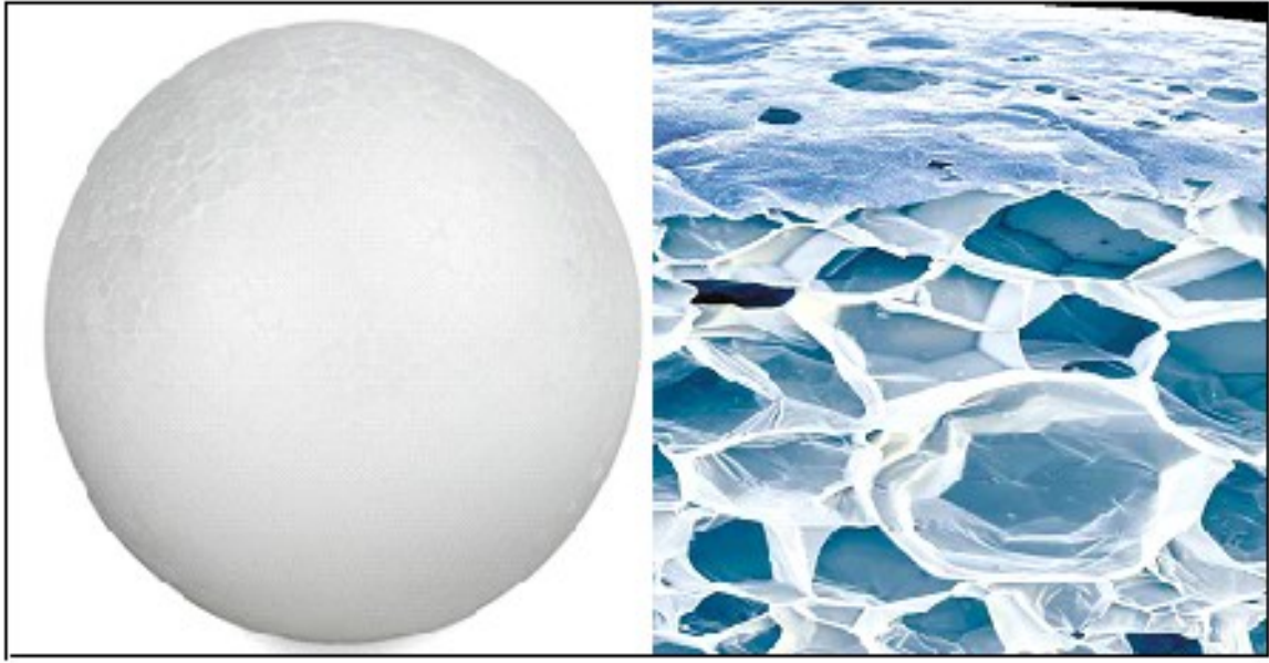
Şekil 2.19. EPS boncuğu ve gözenekli iç yapısı [38]
