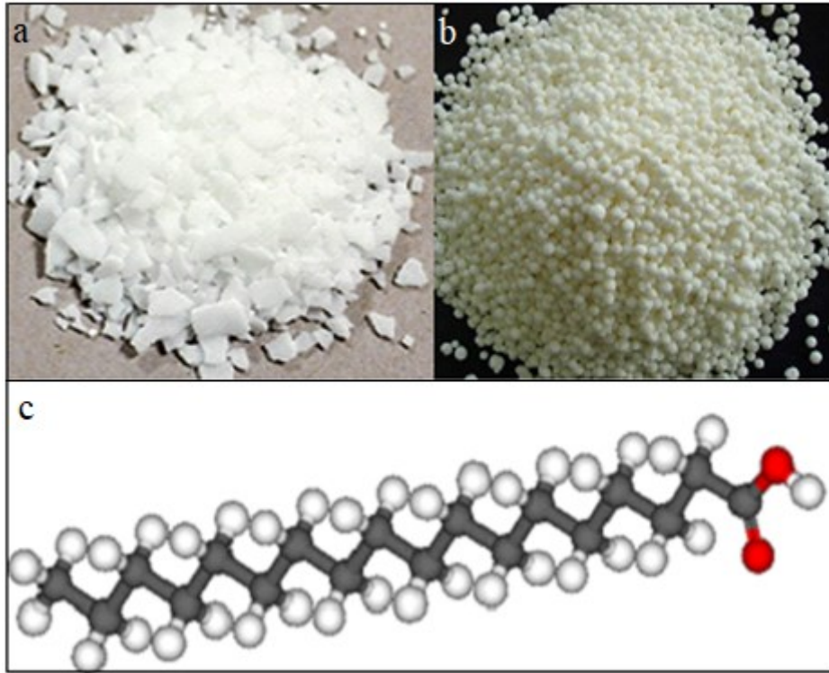
Resim 3.4. Stearik asit: (a,b) SA'nın fiziksel şekli, c) SA'nın kimyasal yapısı
