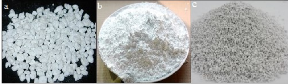
Şekil 2.36. Perlit çeşitleri: a) genişmiş perlit, b) öğütülmüş genişmiş perlit, c) ham perlit [70]
