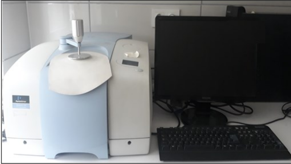
Resim 3.6. Perkin Elmer marka Fourier dönüşümlü kızılötesi (FTIR) spektrometre cihazı
