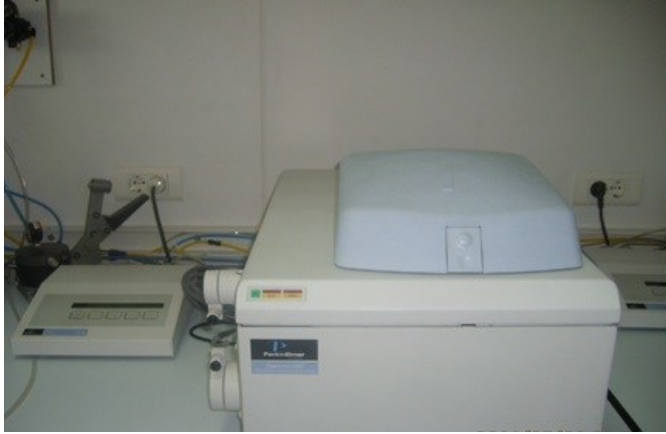
Resim 3.8. Diferansiyel taramalı kalorimetre cihazı [113]
