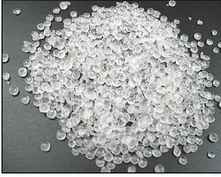
Şekil 2.15. Kristal polistirenin genel görünüşü [33]
