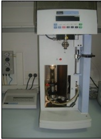
Resim 3.7. Perkin Elmer Pyris 1 termogravimetrik analiz cihazı (TGA) analizörü [113]
