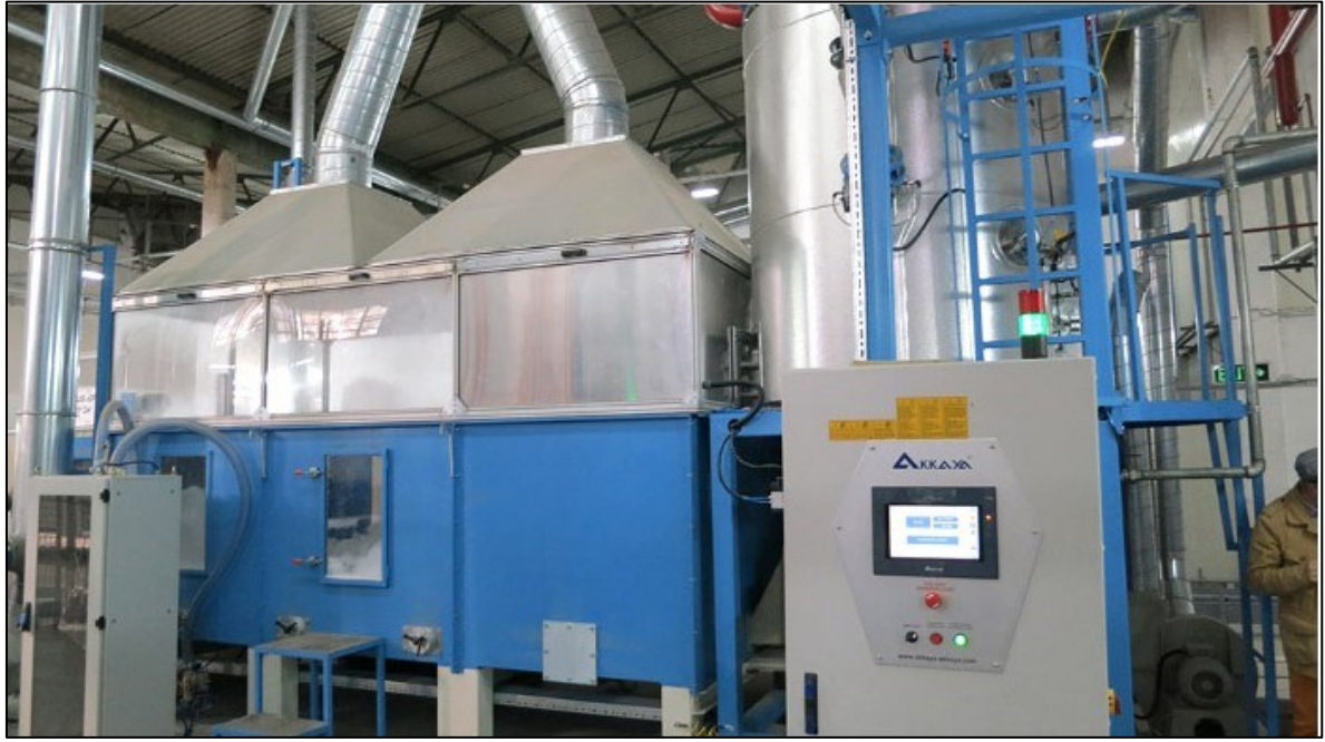
Şekil 2.24. Ön şişirme ünitesi [52]
