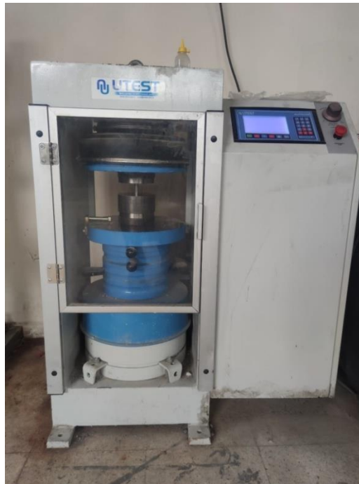
Şekil 1.7. Tek yönlü presleme cihazı
