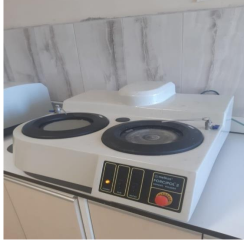
Şekil 2.2. Zımparalama – parlatma cihazı
