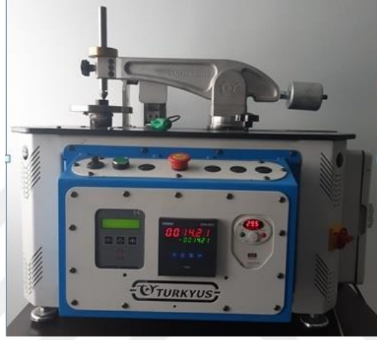
Şekil 2.6. Abrasiv aşınma cihazı
