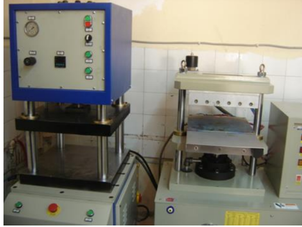
Şekil 3.2: Test parçalarının şekillendirildiği sıcak ve soğuk preslerin fotoğrafı.
