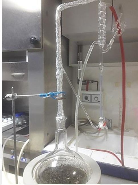
Şekil 3.4. Uçucun yağ tayininde kullanılan clevenger düzeneği
