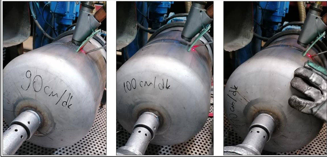
Şekil 3.6 Farklı ilerleme hızlarında hazırlanan numuneler
