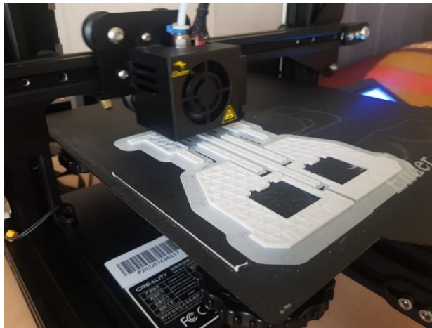
Şekil 17. Üç Boyutlu Yazıcıda Göz Mekanizmasının Tabanının Basımı
