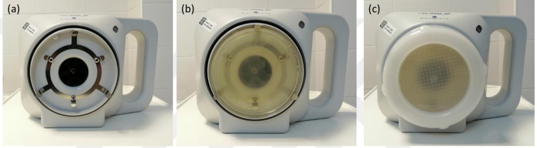
Şekil 2.7. Çalışmada kullanılan hava örnekleme cihazı (a), hava haznesine PCA besiyeri içeren petri kutusunun yerleştirilmesi (b), hava örnekleme işlemi öncesi besiyeri üzerine yerleştirilen elek şeklinde örnek toplama filtresi (c).
