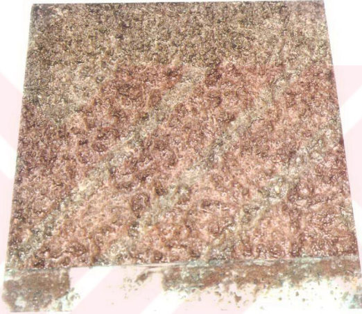
Resim 4.6. Eğimli toprak örneklerinde parmakların oluşması, toprak yüzeyinde su birikimi ve eğim aşağı yüzey akış.
