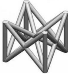
Şekil 2.8: Sortino vd.'nin kullandığı YHMKZ birim hücresi. [9]
