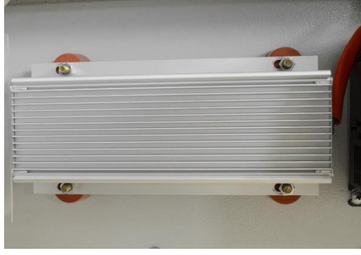
Şekil 4.7: Servo motor sürücü rejeneratif frenleme direnci.
