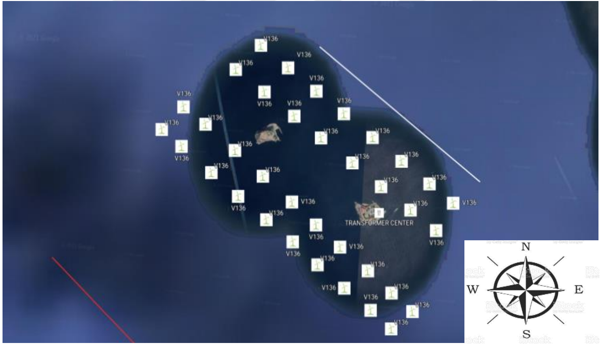
Şekil 6.9 Deniz üstü Rüzgâr Santrali Yerleşimi
