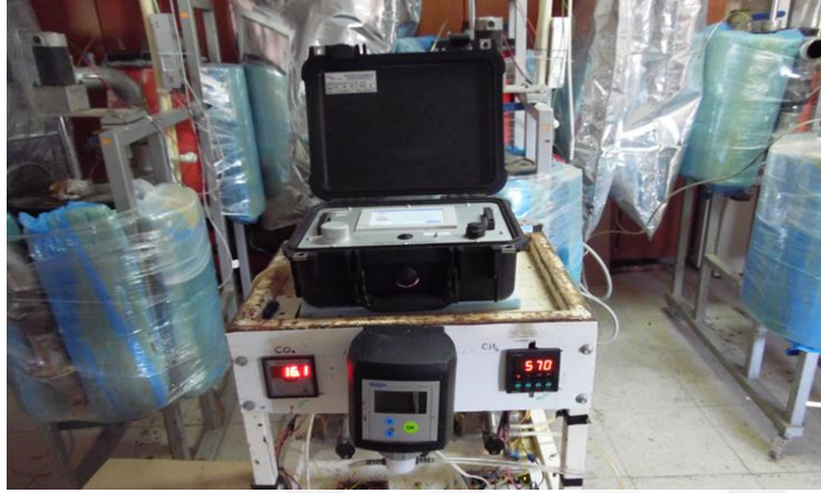
Şekil 3.9. Gaz kompozisyonu belirlenmesi için kullanılan senkronize ünite
