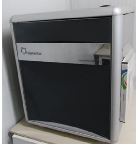
Şekil 3.15. Elementar Vario MAX CN elementel analiz cihazı
