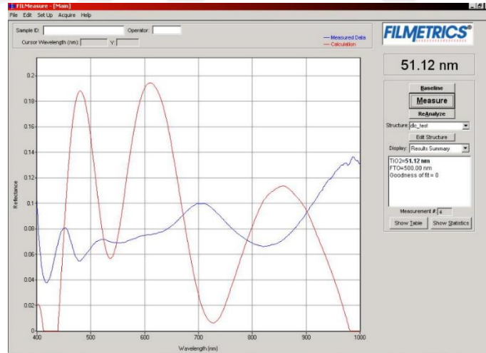
Şekil 5.14. FTO taban üzerine kaplanan katkısız \text{TiO}_2 film kalınlığı
