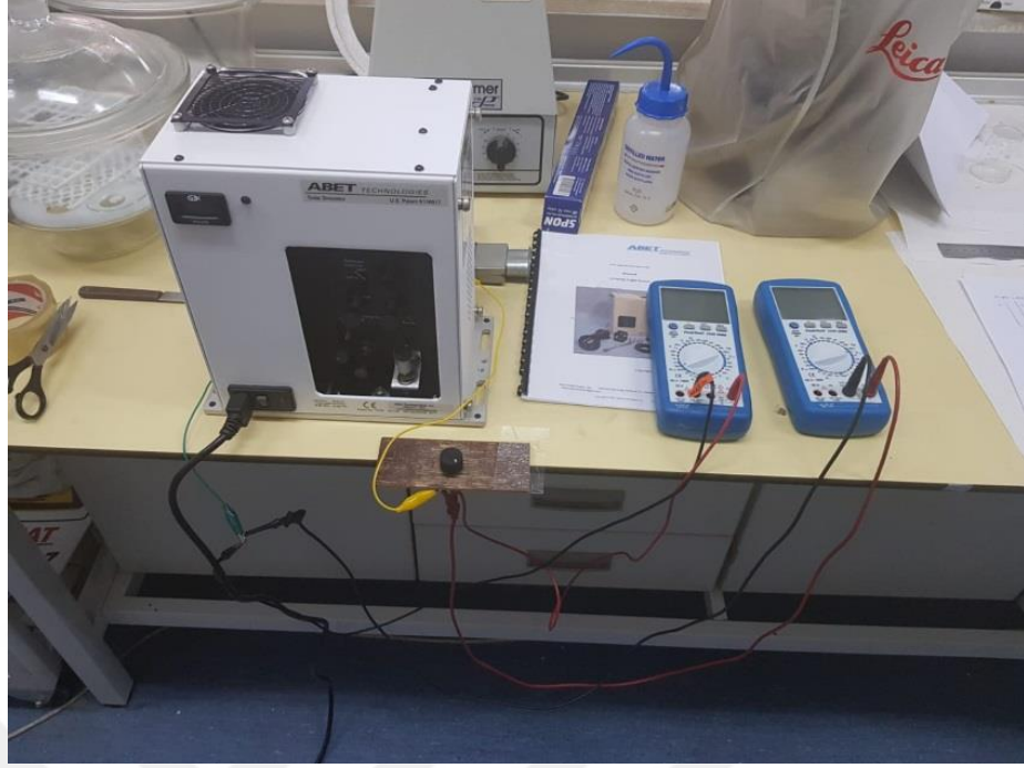
Görsel 6.4. I-V ölçümü için kurulan düzenek
