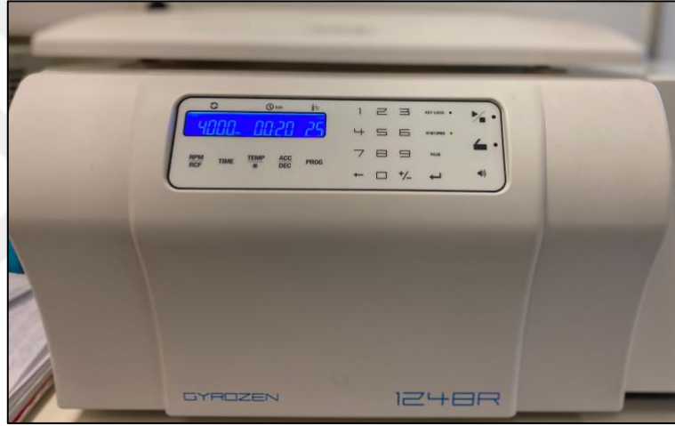
Şekil C1. 3. Santrifüj: Gyrozen 1248 R santrifüj, 0-4000 rpm 4-40 °C aralığında çalışır.
