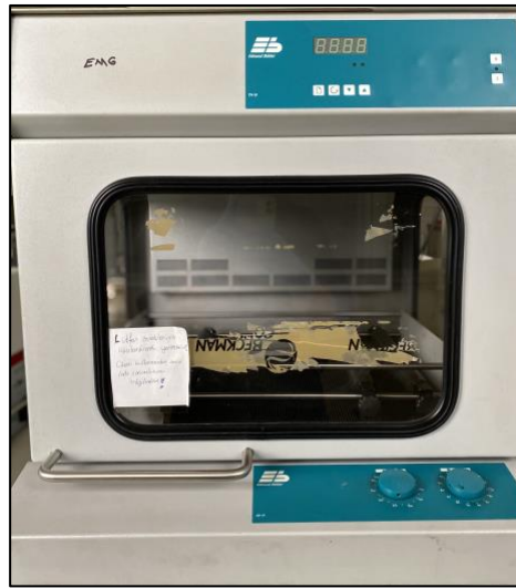
Şekil C1. 1. İnkübatör: Edmund-Bühler TH 15 inkübatör 5-50 °C, 0- 500 rpm aralığında çalışmaktadır.
