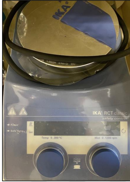
Şekil C1. 5. Manyetik Karıştırıcı: IKA RCT Classic, 50-360 °C , 50-1500 rpm aralığında çalışır.
