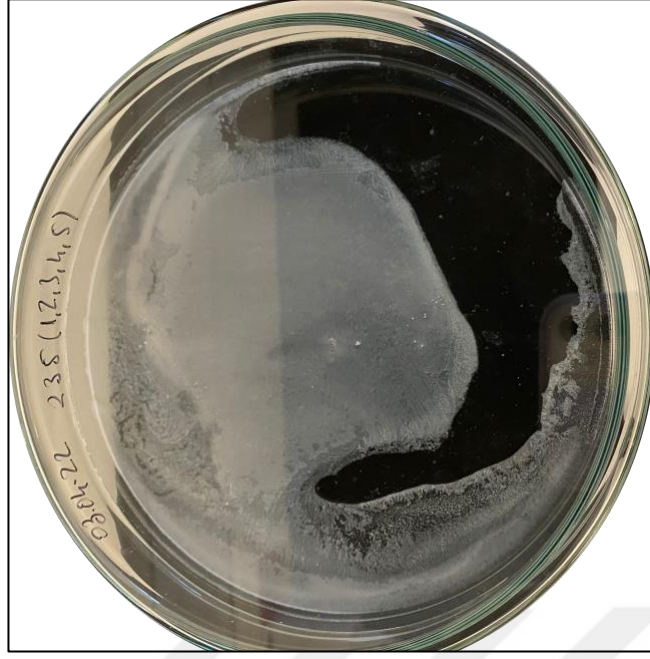
Şekil 10.5: Cam Petri disklerinde kurutulmuş İK3-235'ten elde edilen kitosan beyaz toz halinde görülmektedir.
