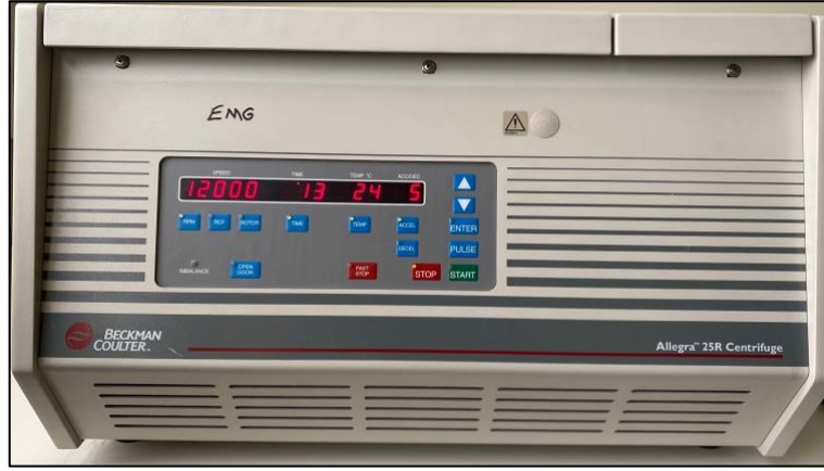
Şekil C1. 2. Santrifüj: Beckman Coulter Allegra 25r santrifüj 0-15000 rpm ve 2-40 °C aralığında çalışır.
