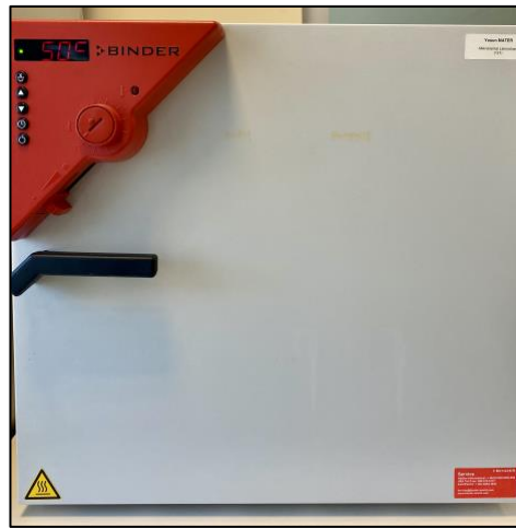
Şekil C1. 4. Etüv: Binder ED 115 Etüv Avantgarde Line With Natural Convection, 5-300 °C aralığında çalışır.
