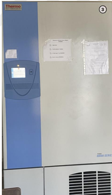
Şekil C1. 6. -80 °C Dondurucu: Thermo Scientific™ Forma™ 88000 Series -86°C Upright Ultra-Low Temperature Freezers, -50- -86 °C aralığında çalışır.
